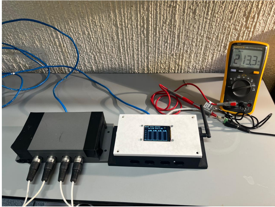
Figura 5.16: Medición de la corriente de alimentación del sistema completo, conformado por el nodo transmisor, el nodo receptor y cuatro sensores MPX4250AP comunicados mediante CAN BUS.
