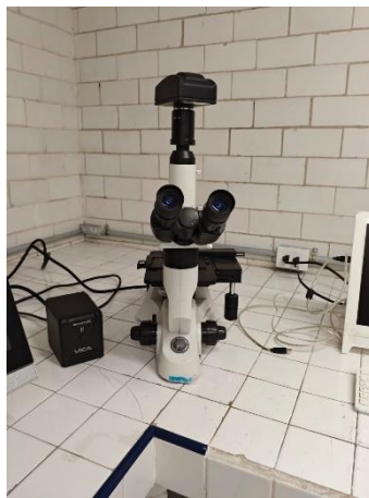
Figura 10. Microscopio metalúrgico invertido de la marca Nikon EPIPHOT 200
