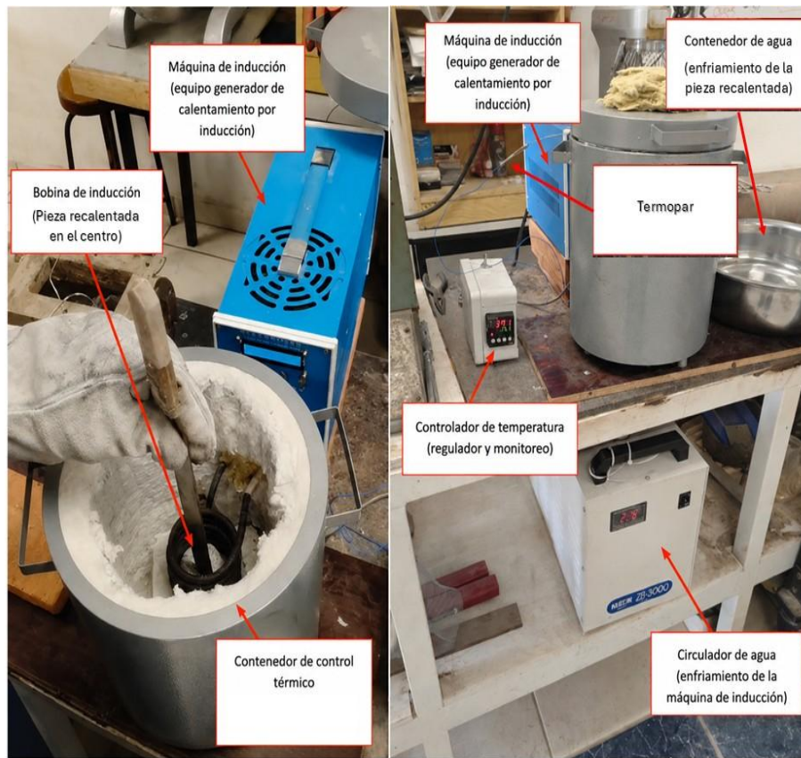
Figura 7. Máquina de calentamiento por inducción de alta frecuencia
