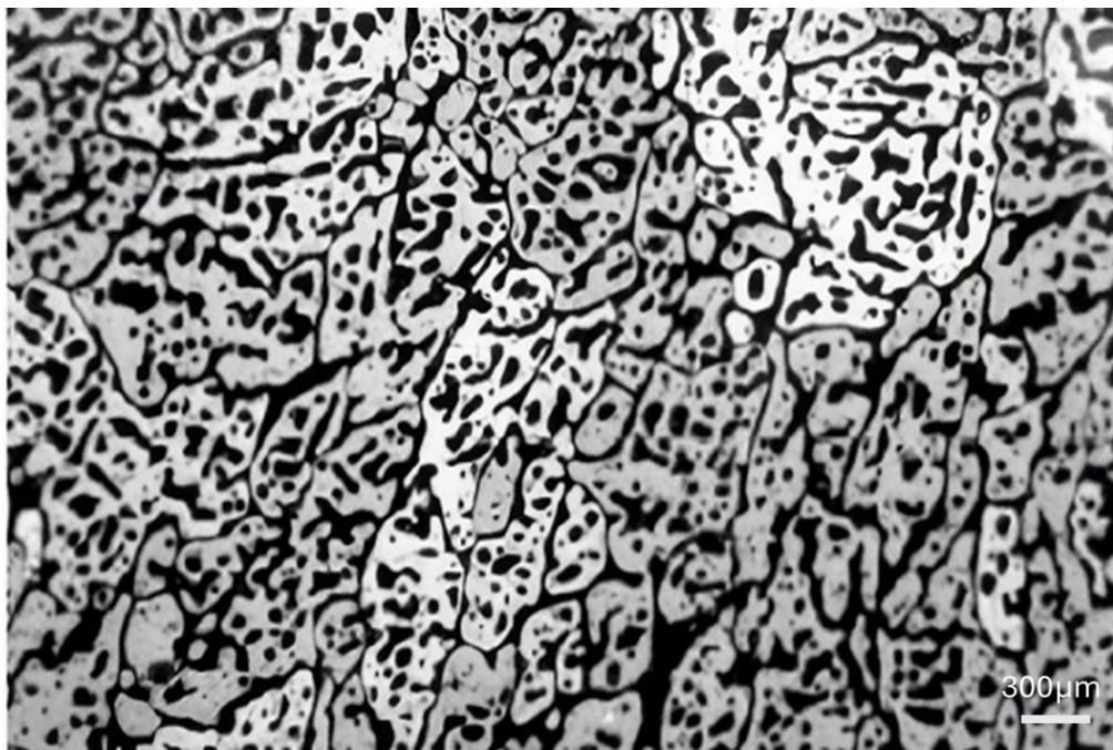
Figura 14. Evolución microestructural de una estructura dendrítica gruesa de A356 durante el recalentamiento a 580 °C por 30 min (Wang et al., citado en Neag y Becker, 2023).
