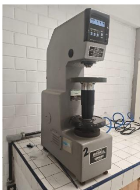
Figura 12. Macrodurómetro Brinell marca NEWAGE, modelo NB 3010
