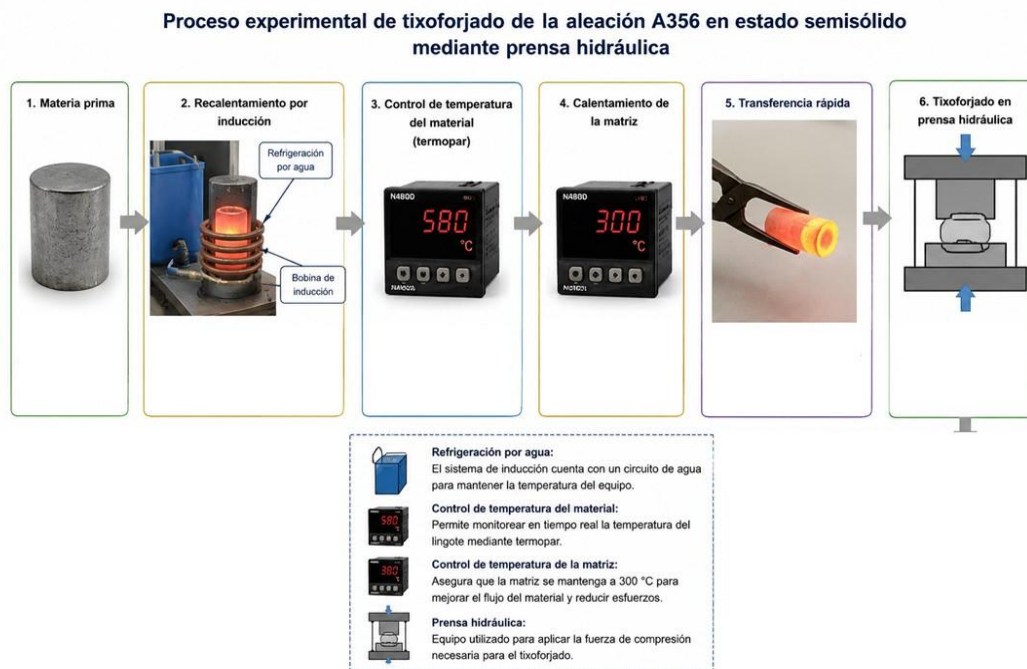
Figura 9. Proceso experimental de tixoforjado de la aleación A356 en estado semisólido mediante prensa hidráulica.
