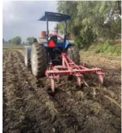
Figura 5. Paso de subsuelo para romper el piso de arado sin voltearlo.
