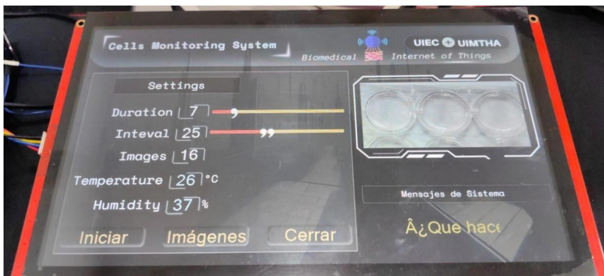
Figura 13. Implementación de Interfaz de Usuario HMI + ESP32-S3. Fuente: Elaboración propia.
