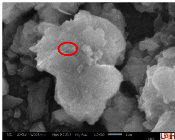
Figura 30. Micrografía y ubicación del análisis puntual en EDS para la mezcla RMDA-1.
