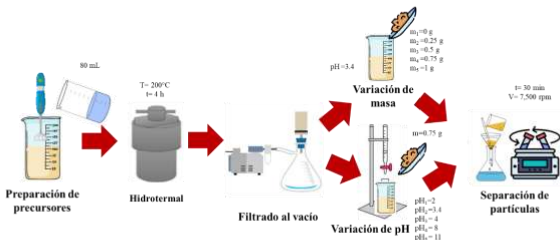
Figura 2. 2. Metodología experimental para la síntesis de los PEG-CQDs.
