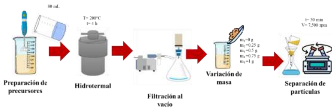
Figura 2. 3. Metodología experimental para la síntesis de los Ch-CQDs.
