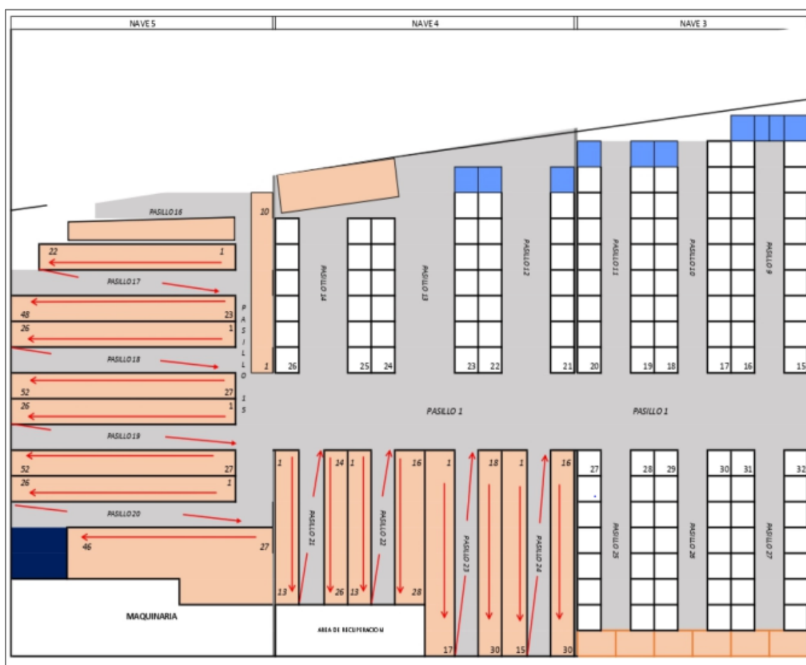
Figura 27. Identificación de cambios en el layout propuesto para almacenamiento.
