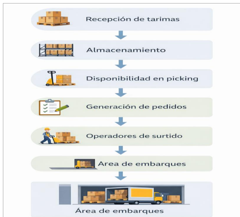
Figura 11. Lógica del modelo de simulación del sistema logístico del CEDIS.
