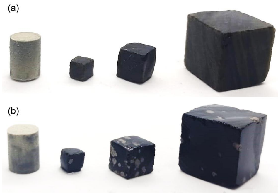
Figura 3.5. Muestras preparadas para los tratamientos térmicos de las variedades V y VP: (a) obsidiana tipo V y (b) obsidiana tipo VP. En ambos casos, las muestras se ordenan de izquierda a derecha como D, C, M y G.
