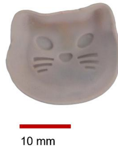
Figura 5.2. Moldes flexibles con geometría de cara de gato utilizados para evaluar la fidelidad geométrica del proceso de conformado, mediante la reproducción de relieves y detalles superficiales.
