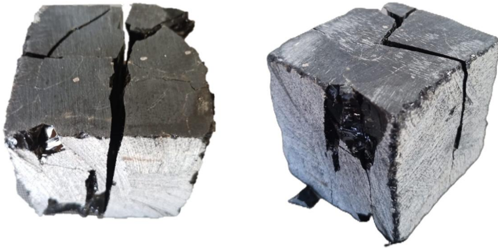
Figura 3.24. Fractura frágil en probetas de obsidiana después del ensayo de compresión.
