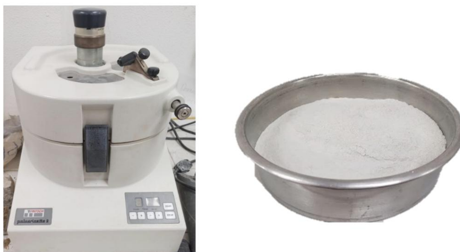
Figura 3.3. Equipo utilizado para la molienda. A la izquierda, molino de mortero de ágata eléctrico FRITSCH PULVERISETTE 2. A la derecha, polvo obtenido después del proceso de molienda.
