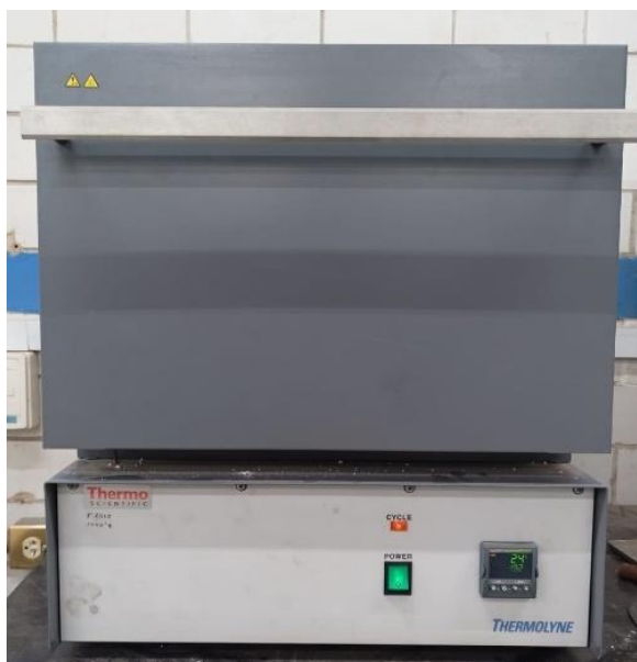
Figura 3.6. Horno eléctrico Thermolyne Thermo Scientific F6010 utilizado para los tratamientos térmicos de las muestras.
