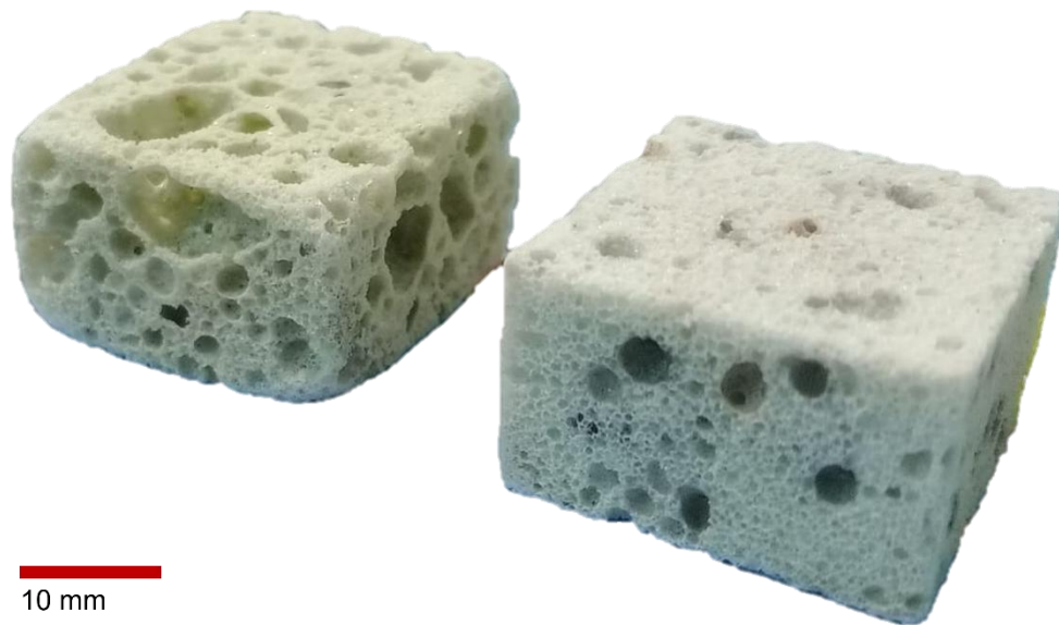
Figura 4.24. Aspecto macroscópico de las muestras de tamaño G empleadas para la evaluación de la conductividad térmica después de la regularización geométrica: (a) V_G C_2_{1100\_90} , ubicada a la izquierda, y (b) V_G B_4_{1100\_10} , ubicada a la derecha. En ambos casos, la medición se realizó considerando exclusivamente la región interna (RI) del material.
