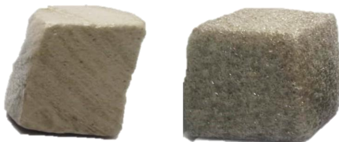
Figura 3.85. Diferencia de expansión macroscópica entre V y VP expandida. A la izquierda muestra V; se observa una expansión preferencial perpendicular al flujo de las vesículas preexistentes. A la derecha muestra VP; la expansión fue más uniforme en sus tres ejes.
