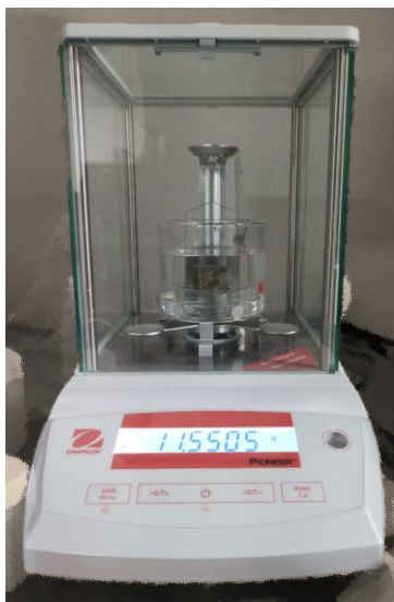
Figura 3.13. Balanza analítica OHAUS Pioneer PX224 y kit empleado para la determinación de la densidad de las muestras tratadas térmicamente.
