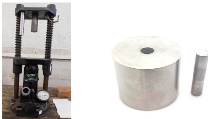
Figura 3.4. Prensa hidráulica (izquierda) y dado metálico (derecha) usados para el conformado de muestras cilíndricas a partir de polvo de obsidiana.
