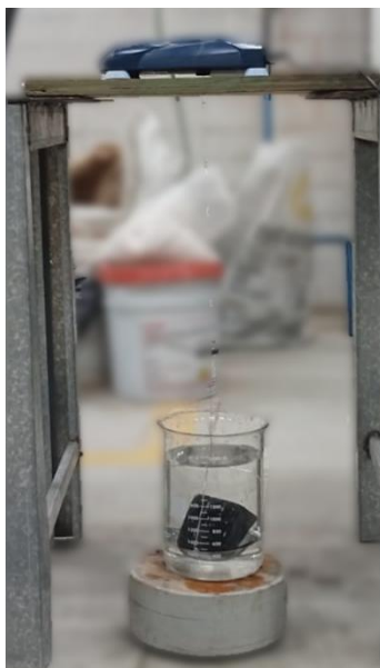
Figura 3.12. Determinación de la masa sumergida ( m_h ) de las probetas durante el ensayo de densidad aparente y porosidad.
