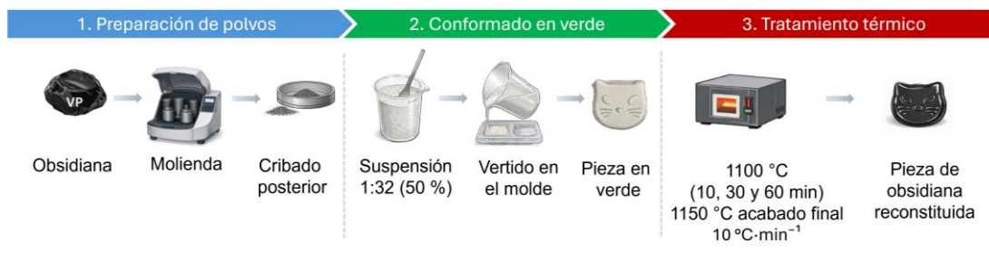
Figura 5.6. Esquema general de la ruta de fabricación de piezas de obsidiana reconstituida, desde la preparación de polvos y el conformado en verde hasta el tratamiento térmico final por sinterización por flujo viscoso.
