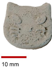
Figura 5.1. Pieza obtenida a partir de polvo de obsidiana y aglomerante con relación almidón/agua 1:8. La alta viscosidad de la mezcla favoreció la retención de burbujas y dificultó la reproducción de los detalles más finos del molde.
