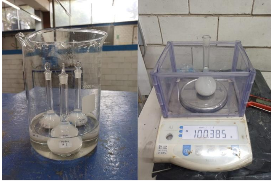
Figura 3.9. Procedimiento de control de temperatura y registro de masa durante la medición de densidad real: A la izquierda, los matraces aforados sumergidos en agua para ajustar la temperatura de la suspensión a 20 y 25 °C. A la derecha, el registro de la masa del matraz con la suspensión a la temperatura de ensayo.
