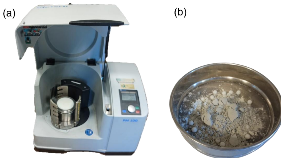
Figura 4.2. Equipos utilizados en la preparación del material: (a) molino planetario RETSCH PM100 empleado para la molienda y (b) tamiz N° 100 utilizado para el cribado de los polvos.
