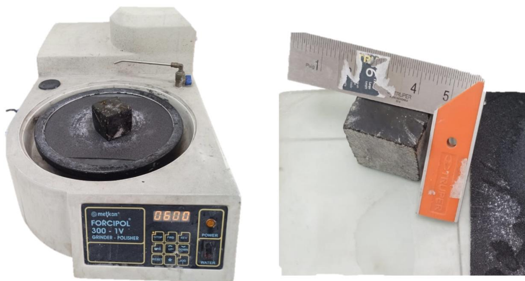
Figura 3.14. Preparación de las probetas para el ensayo de compresión uniaxial: a la izquierda, rectificación mecánica de las superficies en una pulidora Metkon FORCIPOL 300-1 V; a la derecha, verificación de la geometría de la probeta después del acondicionamiento superficial.
