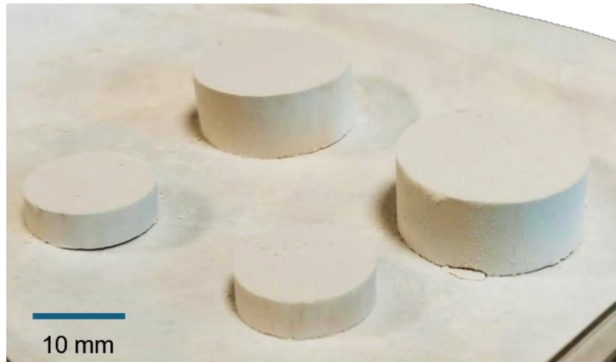
Figura 4.4. Muestras conformadas con diferentes dimensiones. Las muestras de menor tamaño corresponden al grupo C (16 mm de diámetro), mientras que las de mayor tamaño pertenecen al grupo G (25 mm de diámetro).
