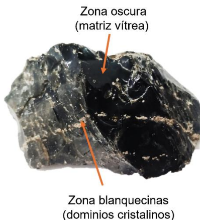
Figura 3.15. Regiones macroscópicas identificadas en la obsidiana tipo VP: zona oscura (matriz vítrea) y zonas blanquecinas (dominios cristalinos).
