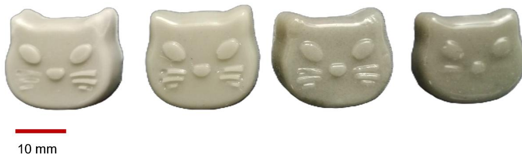
Figura 5.9. Imágenes de las piezas obtenidas tras tratamientos térmicos exploratorios. De izquierda a derecha: 1000, 1050, 1100 y 1150 °C durante 30 min, utilizadas para la selección de la temperatura de trabajo.
