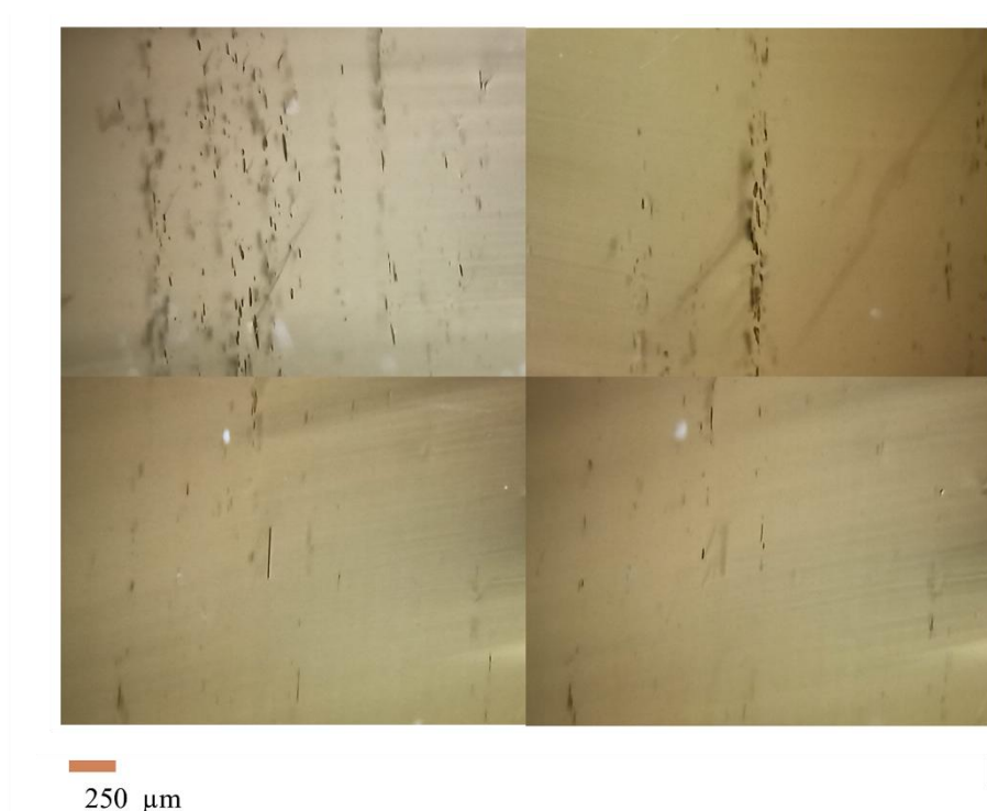
Figura 3.72. Micrografías ópticas de la matriz vítrea de la obsidiana VP sin tratamiento térmico, donde se observan vesículas aciculares localizadas y parcialmente alineadas.
