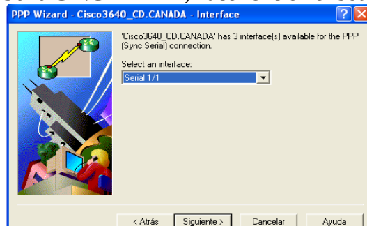
Figura 6.201 Interfaz serial 1/1 del enrutador cisco serie 3640 CD.CANADA
