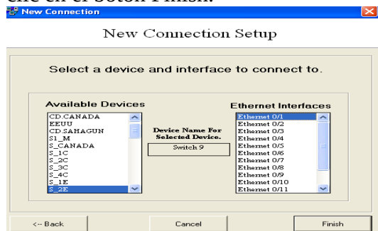
Figura 6.251 Interfaz ethernet 0/1 del switch S_2E
