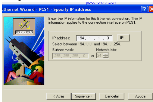
Figura 6.137 Dirección IP de la conexión ethernet de la computadora PCS1
