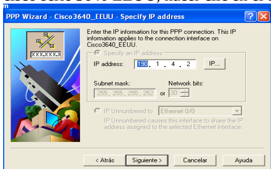
Figura 6.194 Dirección IP del enrutador cisco serie 3640 EEUU para la interfaz serial 1/1
