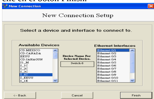
Figura 6.228 Interfaz ethernet 0/1 del switch S_4C
