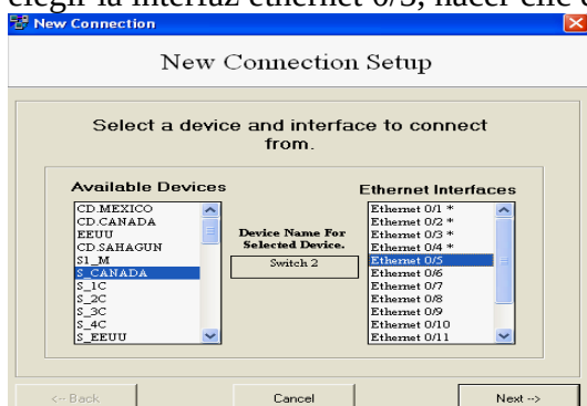
Figura 6.227 Interfaz ethernet 0/5 del switch S CANADA
