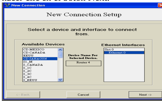
Figura 6.273 Interfaz ethernet 0 del enrutador cisco serie 3640 CD.SAHAGÚN
