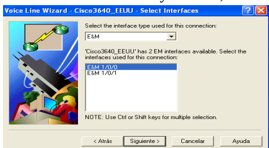
Figura 6.121 Interfaz de conexión entre el enrutador cisco serie 3640 EEUU - PBX
