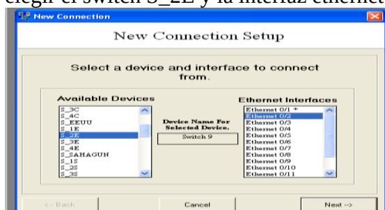
Figura 6.260 Interfaz ethernet 0/2 del switch S_2E
