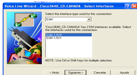
Figura 6.81 Interfaz de conexión entre el enrutador cisco serie 3640 CD.CANADA - PBX
