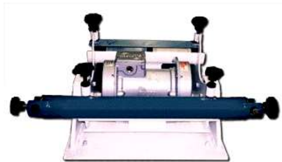
Fig. 2.7. Molino Vibratorio [Retsch GmbH]
