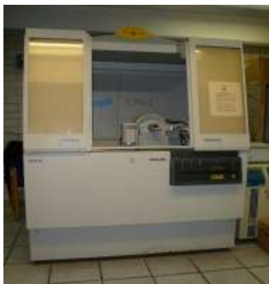
Fig. 3.2. Difractómetro de Rayos X (DRX).
