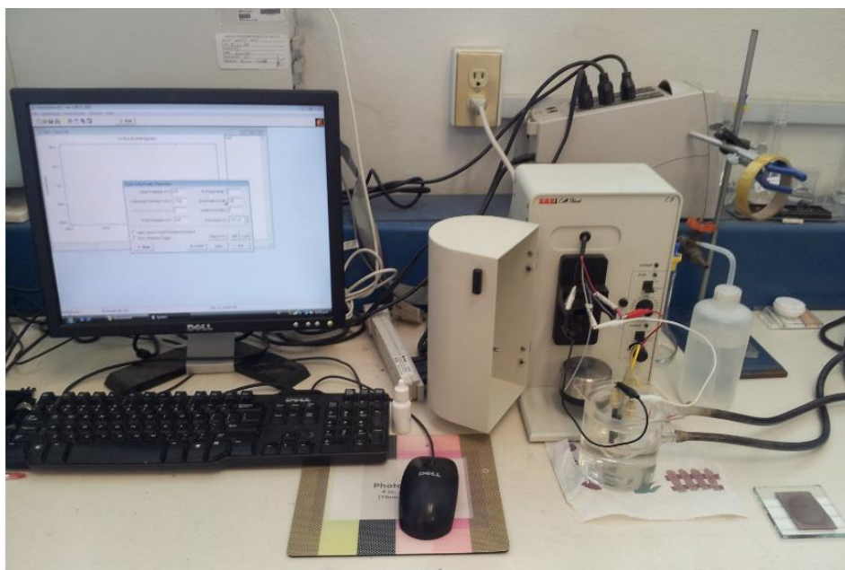
Figura (4.1) Imagen del potenciostato EPSILON conectado al ordenador personal que ejecuta el software de BASI EPSILON EC, junto con la celda electroquímica utilizada durante los experimentos.
