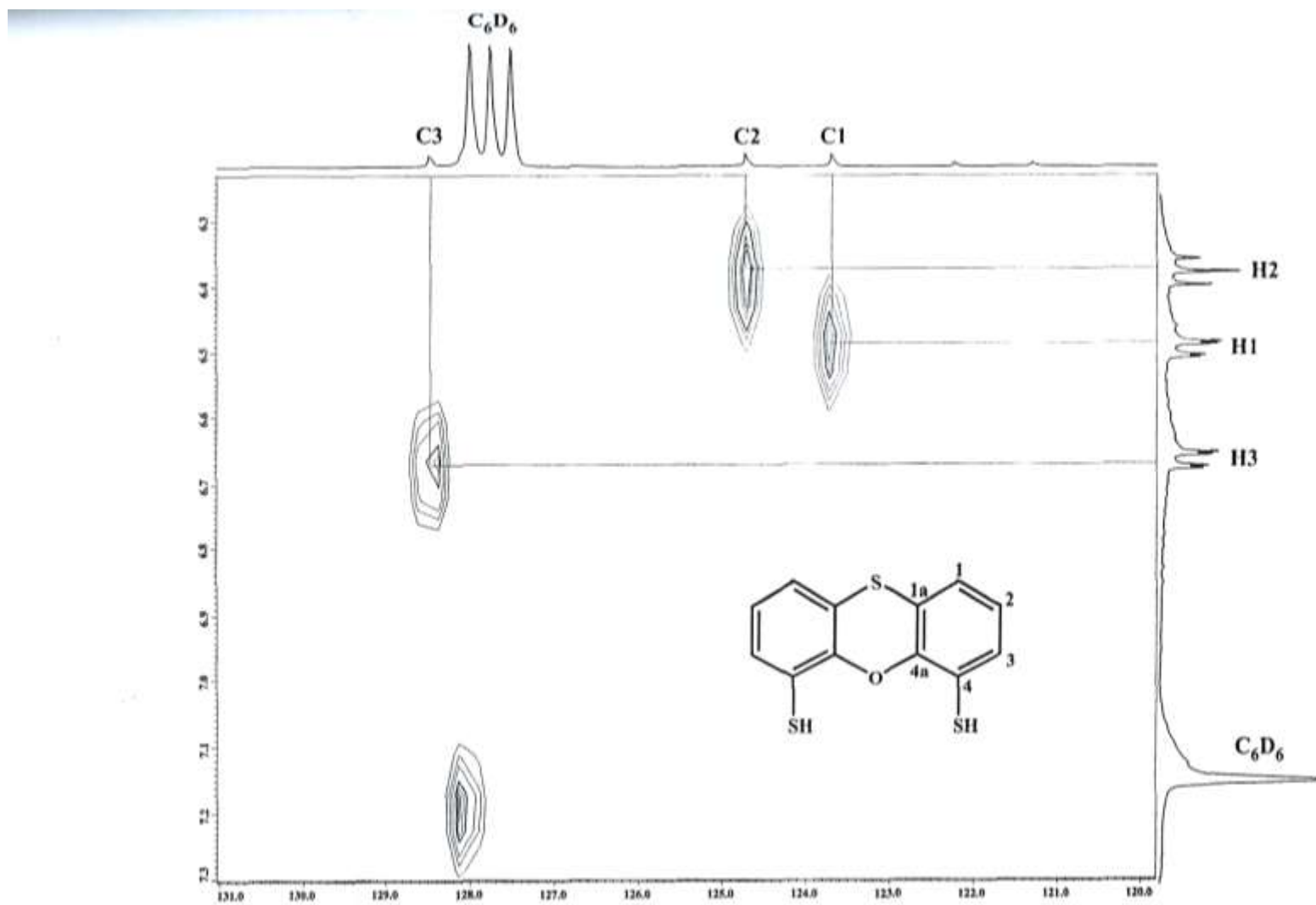
Figura 5.14. Espectro de correlación heteronuclear en dos dimensiones HETCOR [ ^{13}C - ^1H ] del compuesto 1 en C_6D_6 a temperatura ambiente.
