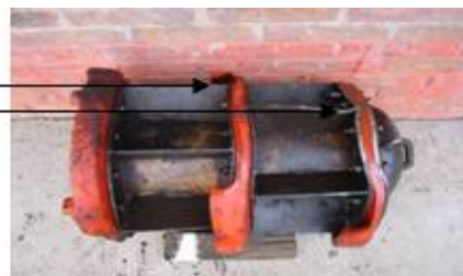
Figura 2.6 Copas rotas de DIM de limpieza. Fuente: Imagen tomada en la corrida de DIM el día 10 de abril del año 2006
