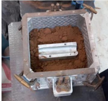
Figura 17 Inicio del proceso de moldeo en arena. Fuente propia
