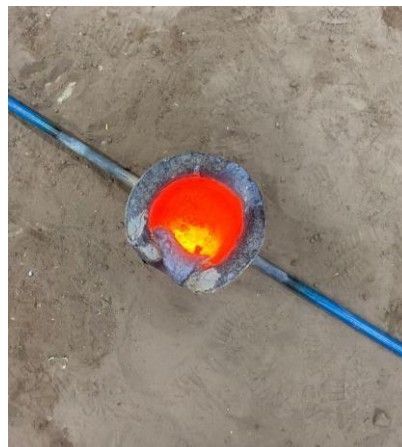
Figura 21 Material fundido proveniente de la cuba. Fuente propia
