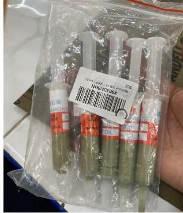
Figura 32 Pasta de diamante para los acabados finales de las probetas, aplicada con algodón. Fuente propia
