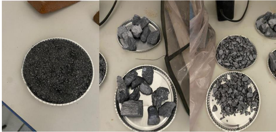
Figura 24 Ferroaleaciones utilizadas en el proceso de fusión. De izquierda a derecha; Grafito, ferro-silicio y ferro-niobio. Fuente propia
