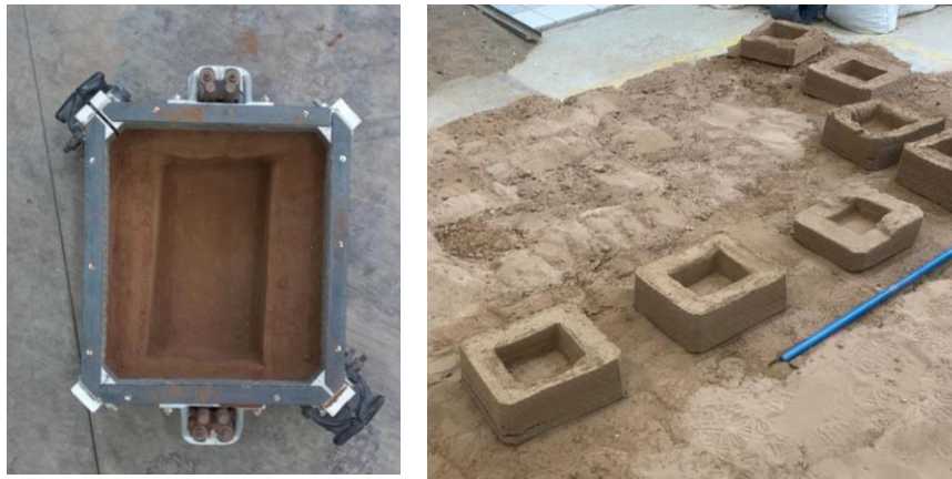
Figura 18 a) Derecha: secado b) Izquierda: desmolde de cajas. Fuente propia
