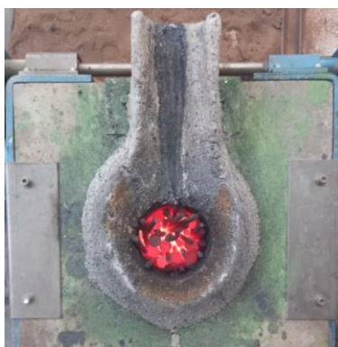
Figura 19 Fundición de carga de chatarra como preparación del horno. Fuente propia
