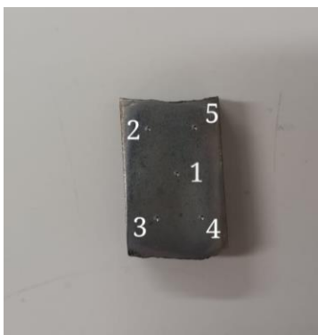
Figura 48 Puntos de prueba de dureza en la probeta de 90 minutos a 300°C. Fuente propia
