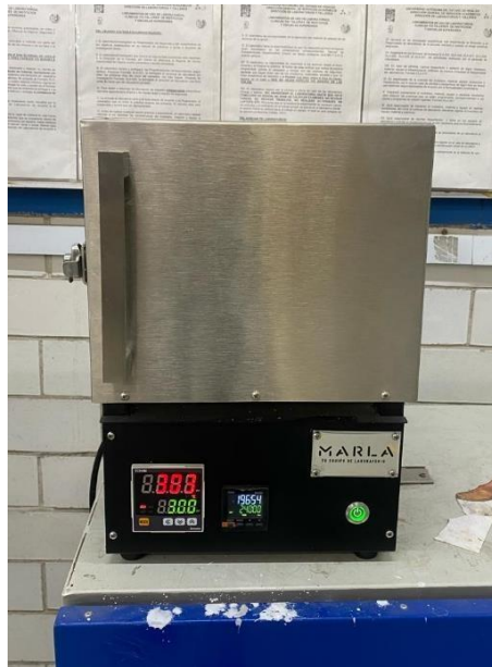
Figura 27 Segundo horno utilizado donde se llevó a cabo el enfriamiento en baño de sales. Fuente propia
