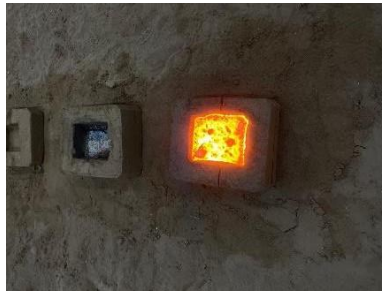
Figura 22 metal recién vaciado en moldes de arena donde se dejó enfriar hasta temperatura ambiente. Fuente propia
