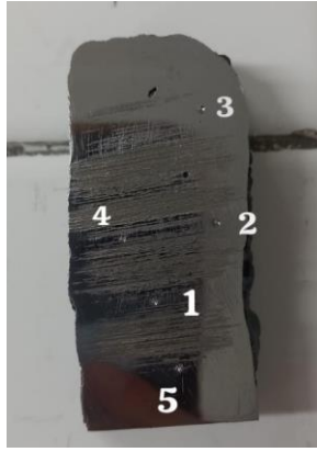
Figura 45 Puntos de prueba de dureza en segunda probeta de material base. Fuente propia
