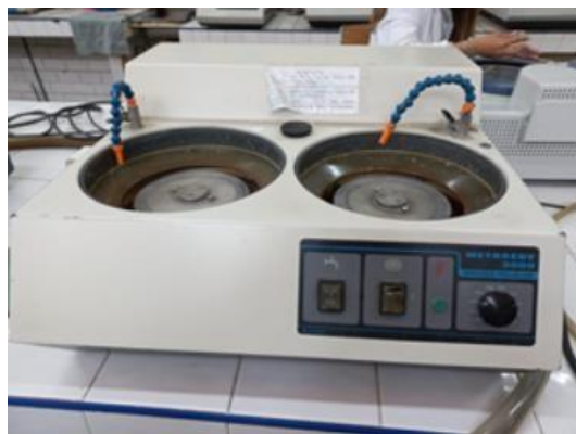
Figura 30 Pulidora de doble disco donde se realizó el desbaste de probetas. Fuente propia
