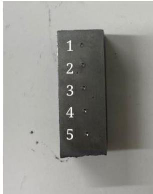
Figura 49 Puntos de prueba de dureza en la probeta de 30 minutos a 350°C. Fuente propia
