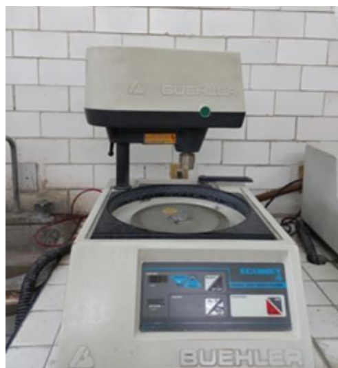
Figura 31 Pulidora de un disco. Se utilizó con un paño para la etapa final de la caracterización. Fuente propia
