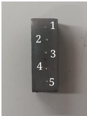
Figura 50 Puntos de prueba de dureza en la probeta de 60 minutos a 350°C. Fuente propia
