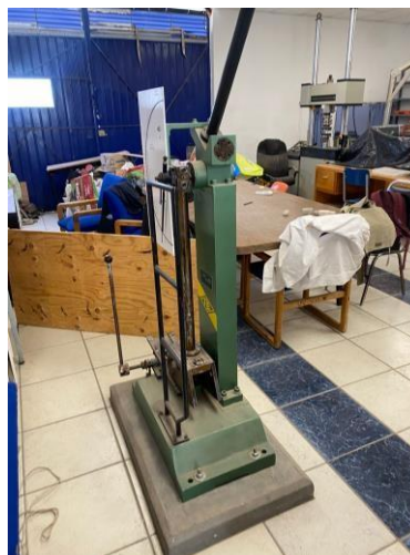
Figura 35 Péndulo de ensayo Charpy Modelo IT-30. Fuente propia
