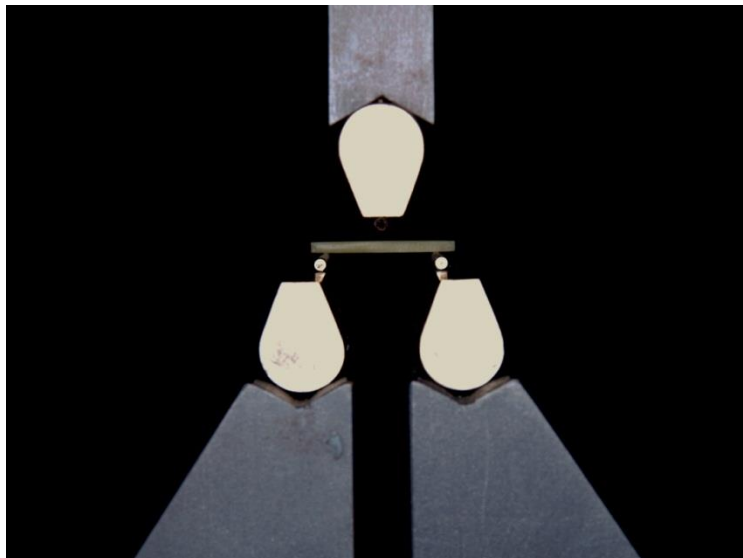
Figura 6. Ensayo de flexión de tres puntos
