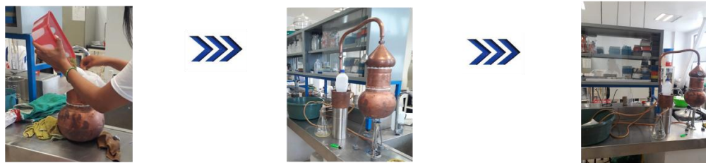
Figura 3. Obtención de aceite esencial de Lippia graveolens por arrastre de vapor.
