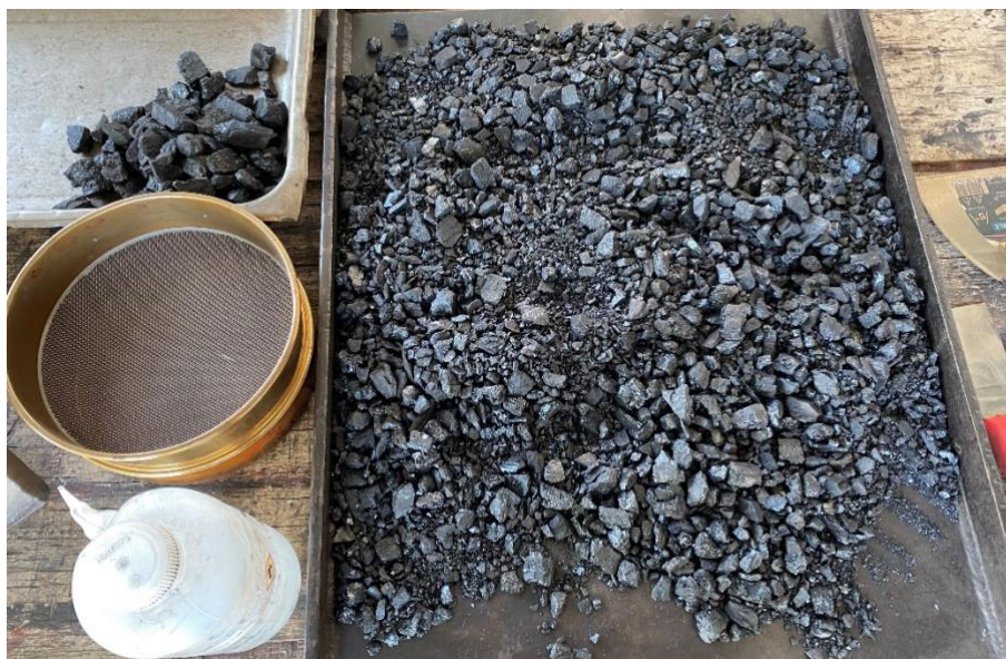
Figura 21. Homogenización de muestra de carbón.
