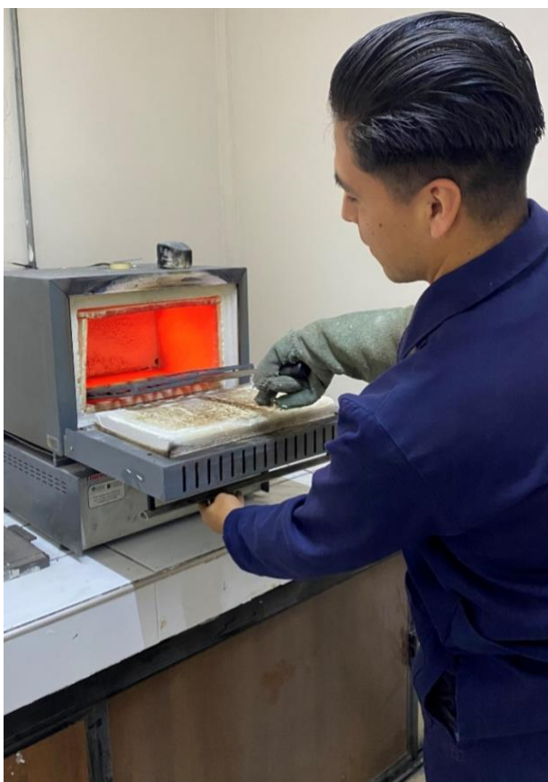
Figura 29. Análisis en muestras de carbón para determinar el Índice de Hinchamiento (FSI) del material sedimentario.
