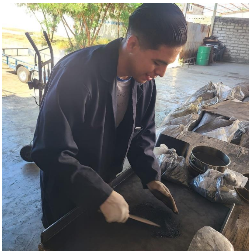
Figura 23. Muestra de carbón bajo malla #60, posterior a su trituration para homogeneizar la muestra.
