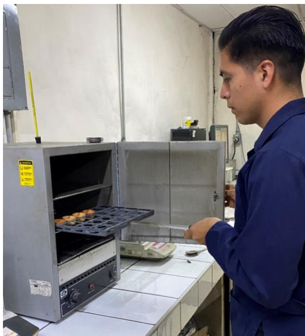
Figura 28. Análisis en muestras de carbón para determinar el porcentaje de ceniza.
