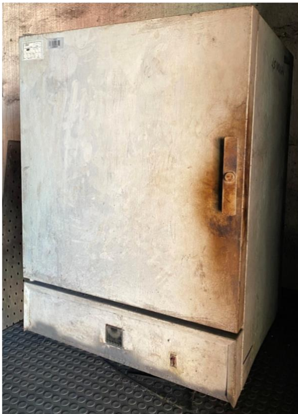
Figura 11. Estufa para el secado de muestras para análisis de humedad total de carbón.
