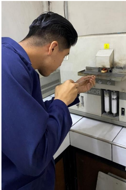
Figura 27. Inicio de análisis para determinar la cantidad de azufre en la muestra de carbón.
