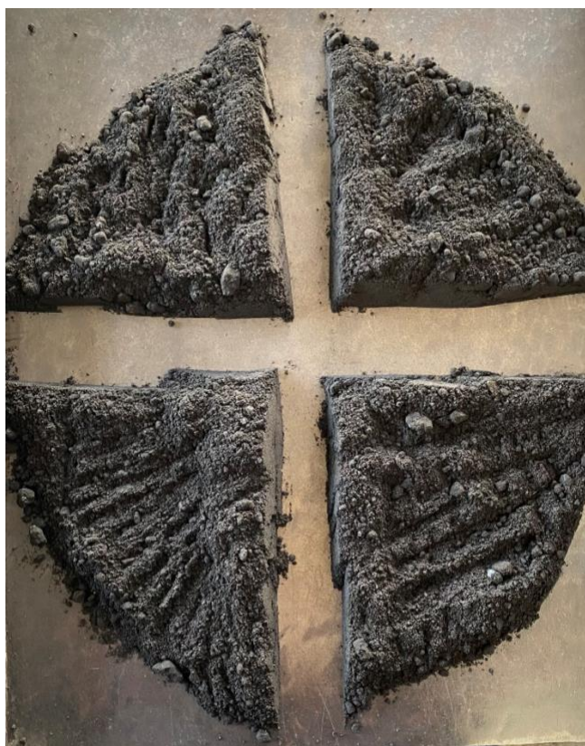
Figura 8. Procedimiento de cuarteo en material sedimentario (carbón).
