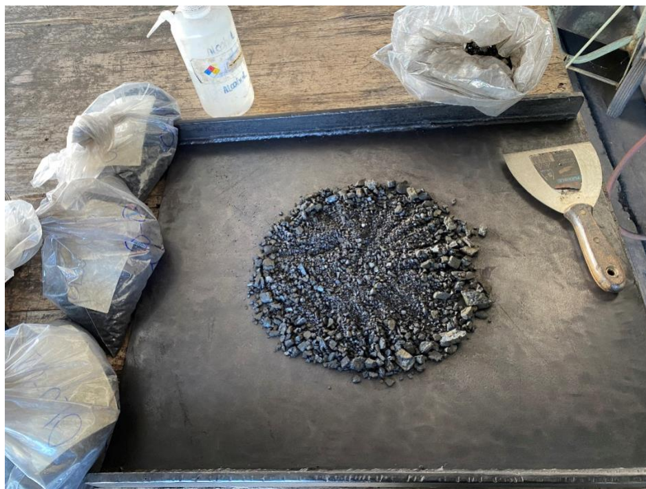
Figura 22. Preparación de muestra de carbón para comenzar con el proceso de trituration bajo malla #60.
