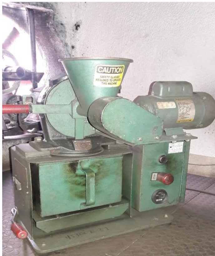
Figura 7. Pulverizador 500 DG (La muestra es quebrada por medio de unos martillos internos que giran a 10,000 rpm.
