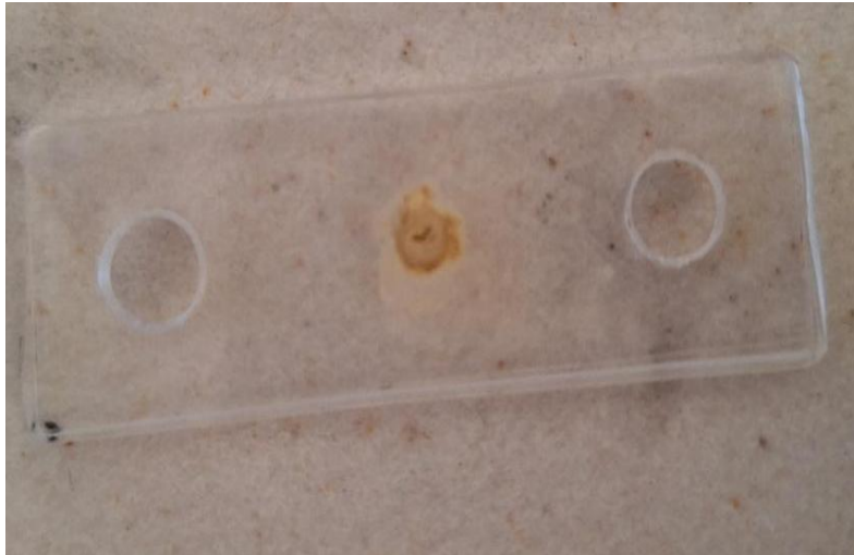
Figura 24 Segunda Pila Li-Mn sobre una placa de acetato
