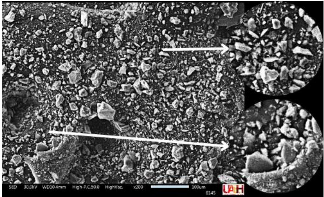
Figura 12 Microscopia Jarosita (Jal-Mn) aumento 200x
