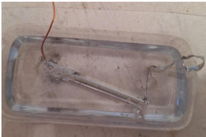
Figura 27 Diseño de Pila para Curvas de Descarga
