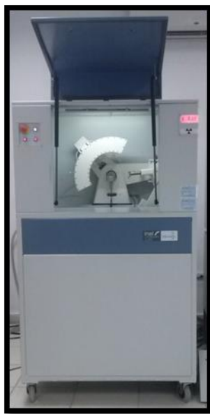
Figura 3 Difractómetro de Rayos X del Área Académica de Ciencias de la Tierra y Materiales
