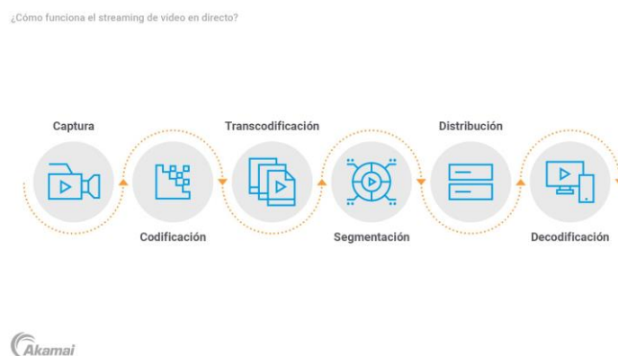
Fig. 3 Elementos del proceso de comunicación de video digital.
