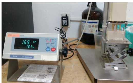
Figura 24. Determinación de viscosidad en yogur.
