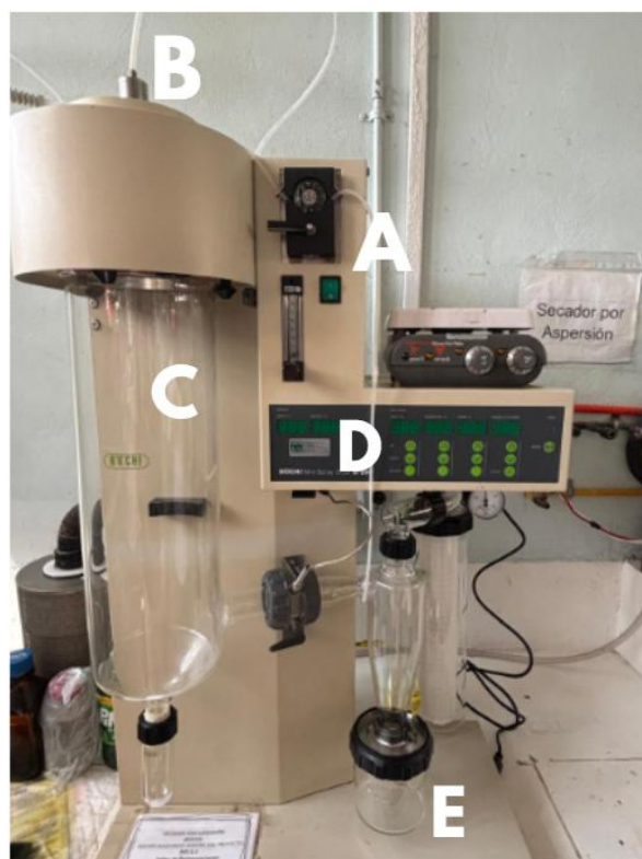
Figura 5. Secador por aspersión tipo BUCHI modelo B-29. Partes del equipo: A) Entrada de la solución, B) Atomizador, C) Cámara de secado, D) Panel de control y E) Colector de polvo. Fuente propia (2025).
