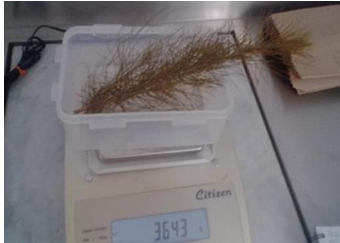
Figura 27 Medición de la biomasa aérea seca a través del empleo de una balanza analítica precisa
