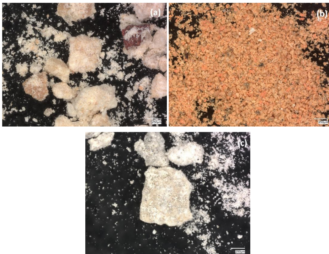
Figura 8. Microscopías a 100X de aumento para (a) mordenita, (b) ladrillo, y (c) agregados de concreto.
