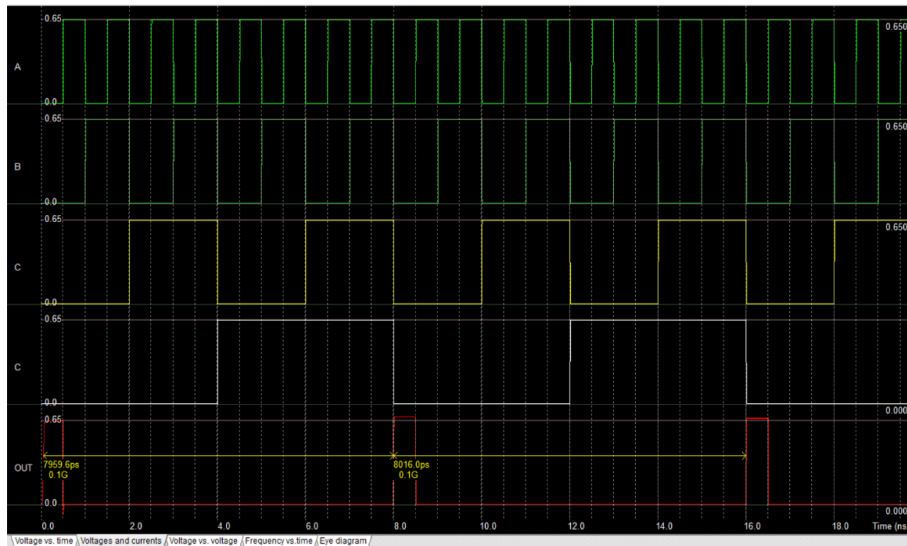
Ilustración 42 Simulación NOR de 4 entradas del layout (0.65V, 100 MHz), (Microwind).
