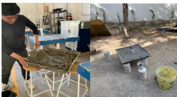
Figura 15. Elaboración y curado de especímenes de concreto permeable con carbón activado.
