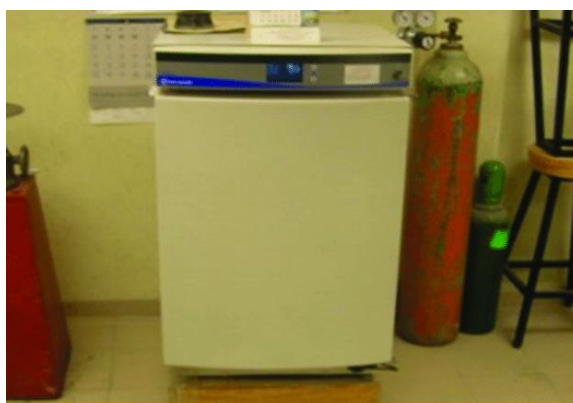
Figura 13. Cámara de carbonatación acelerada comercial por Campos Silva, A. R., Fajardo San Miguel, G., & Mendoza-Rangel, J. M. (2016).
