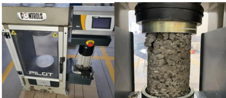
Figura 22. Máquina y cilindro para la prueba de compresión.
