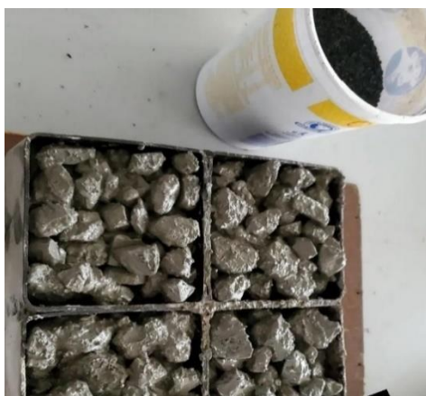
Figura 18. Muestras de concreto para la prueba de captación de CO 2 .
