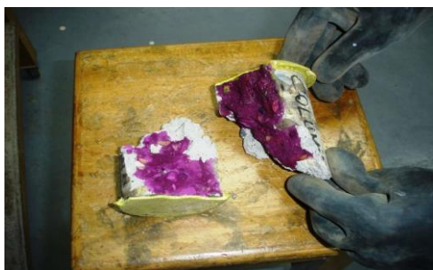
Figura 6. Ejemplo de la aplicación de fenolftaleína en una probeta recién partida de concreto por Osorio, J. D. (2023).
