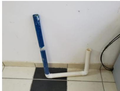
Figura 23. Adaptación de permeámetro hecha a base de PVC.
