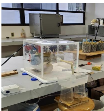
Figura 14. Cámara de carbonatación in vitro para la evaluación de los especímenes de concreto permeable modificados
