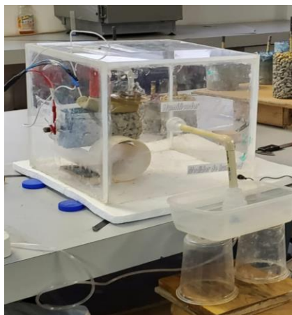
Figura 25. Núcleo de concreto B expuesto en la cámara de carbonatación in vitro.
