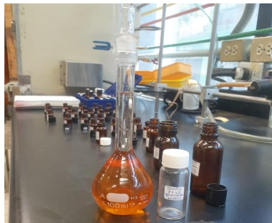
Figura 8. Fracción semipurificada 1.2.13 (S) disuelta en acetona y aforada a 100 mL en el matraz volumétrico, con los viales etiquetados para realizar cada tipo de prueba.
