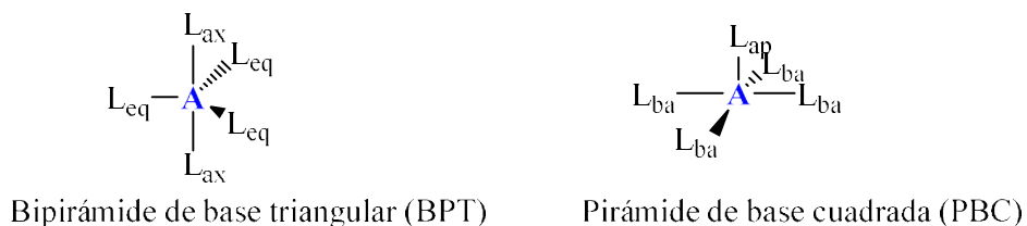
Figura 4. Compuesto general hipervalente con número de coordinación 5, tipo BPT o PBC (ax: posición axial; eq: posición ecuatorial; ba: posición basal; ap: posición apical).
