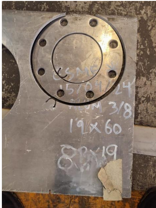
Figura 114. Placa procesada con dimensiones incorrectas. Fuente creación propia.
