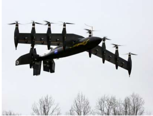
Figura 1.2: UAV tipo Tilt wing GL-10 Greased Lightning desarrollado por la NASA [1].
