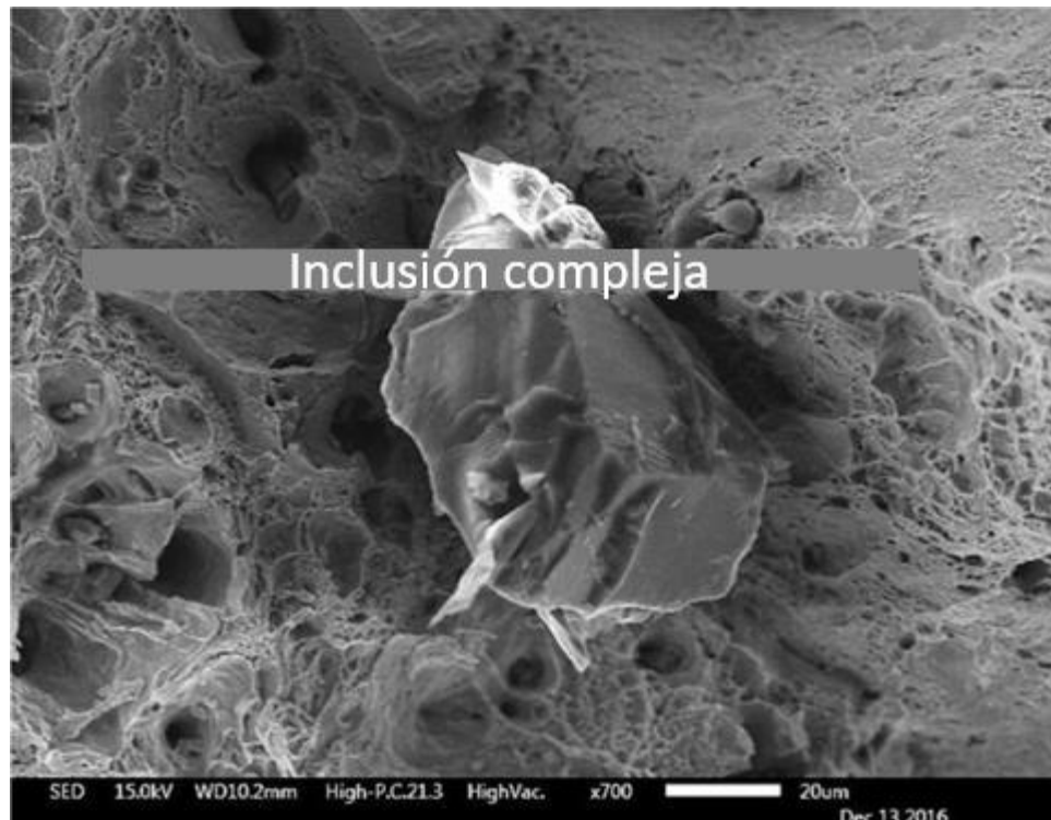
Figura 98 Inclusión compleja formada por O 2 , Si, Al, Ca, Mn y S - acero forjado 38MnV11S+Ca.
