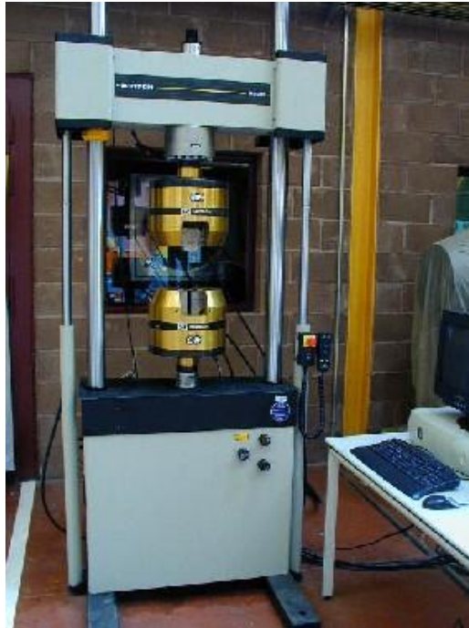
Figura 57 Maquina servo hidráulica para ensayos mecánicos.
