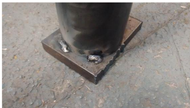
Figura 21 Soldadura de placa de acero de 25 mm para direccionar la solidificación.
