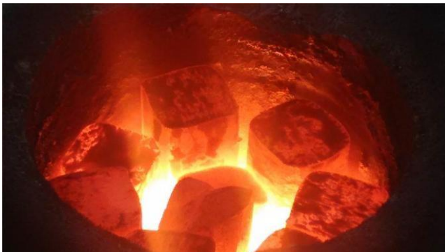
Figura 35 Inicio de la fusión de la palanquilla de acero.
