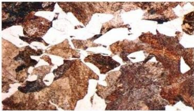
ACERO 39MnV11S+Ca EN ESTADO DE COLADA ESTRUCTURA FERRITA – PERLITA, NITAL, 500X
