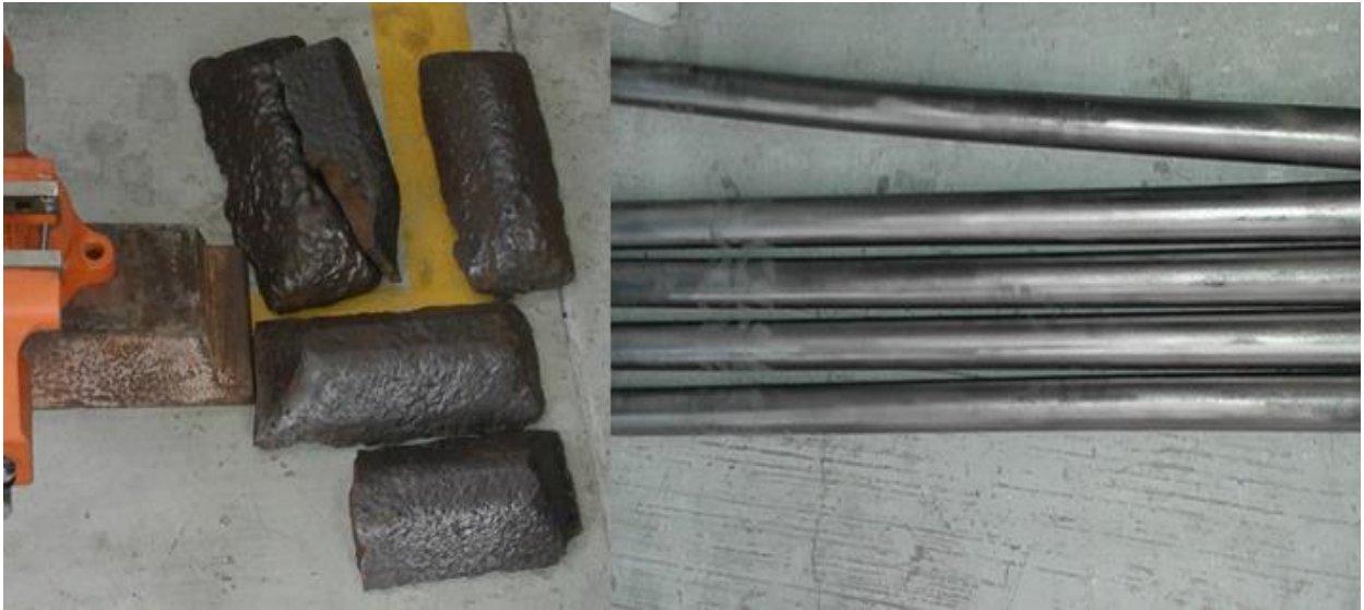
Figura 29 Sorel (arrabio) y palanquilla de acero limpios.
