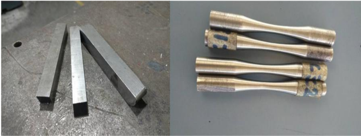
Figura 90 Probetas para ensayo de fatiga de aceros forjados 38MnV11S+Ti
