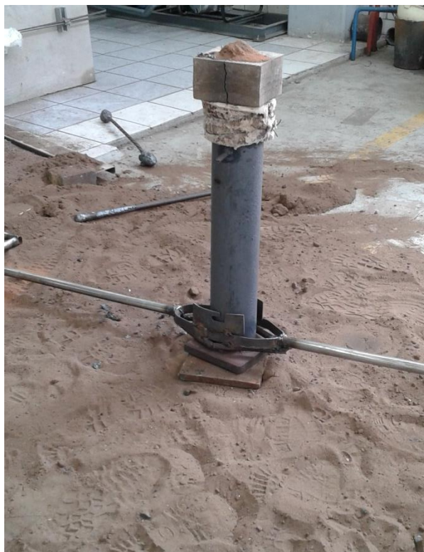
Figura 47 Lingotera con mazarota y colcha refractaria al término del proceso de solidificación.
