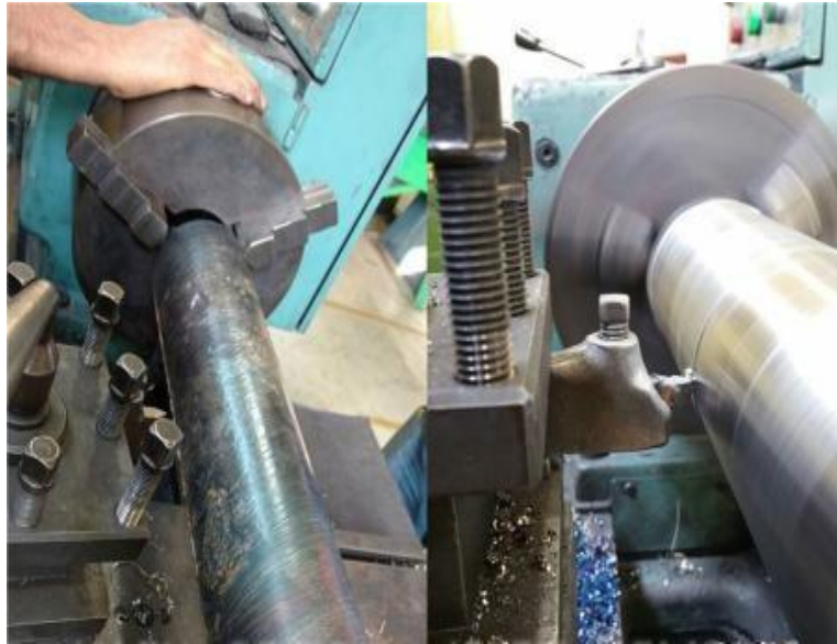
Figura 85 Maquinado burdo de los lingotes de acero colados 38MnV11S+Ti
