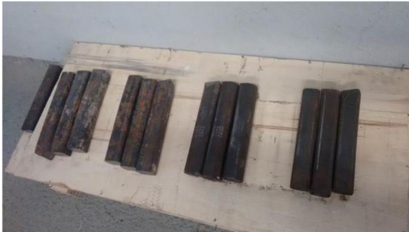
Figura 25 Materia prima de palanquilla de acero seleccionada para la fundición del acero 38MnVS.
