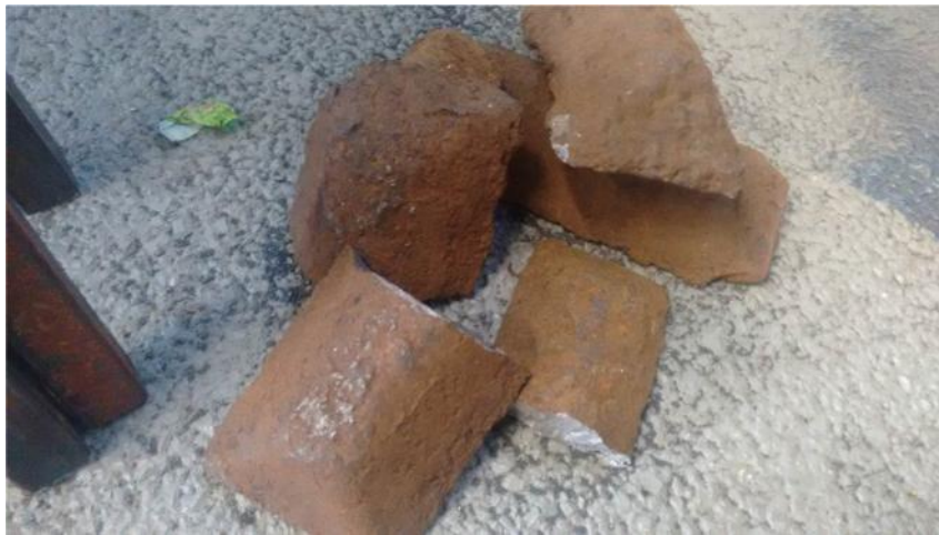
Figura 27 Material Sorel para el ajuste del contenido de carbono.
