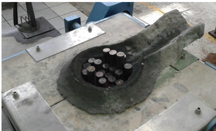
Figura 33 Colocación de palanquilla dentro del crisol.
