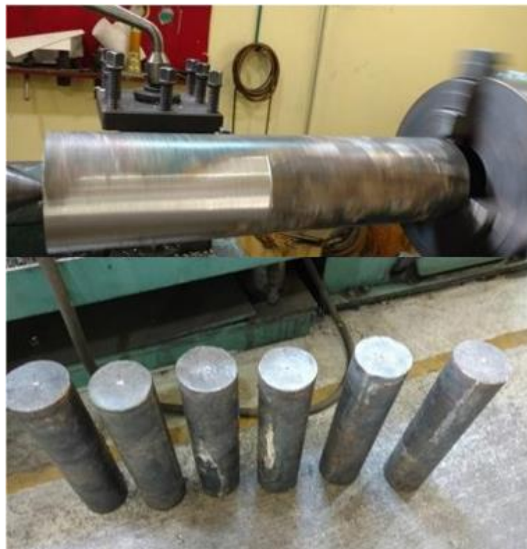
Figura 86 Maquinado burdo de los lingotes de acero colados 38MnV11S+Ti
