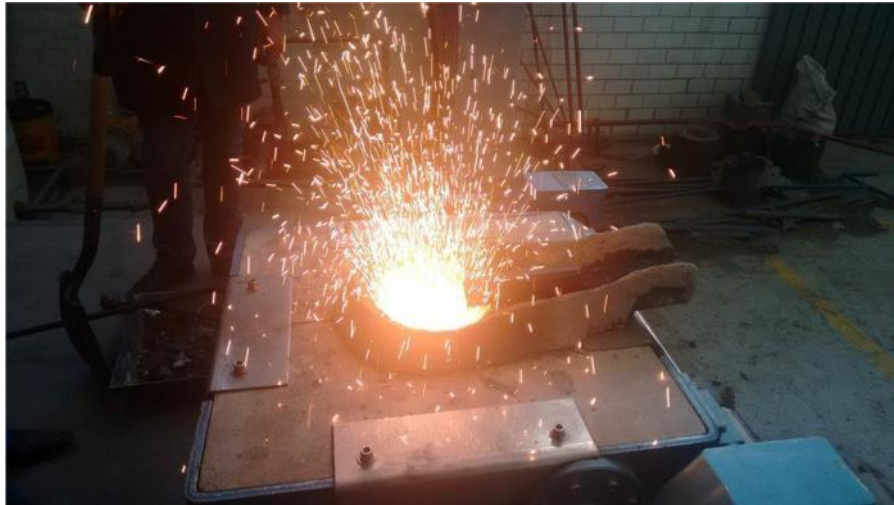
Figura 38 Metal fundido con presencia de oxidación.
