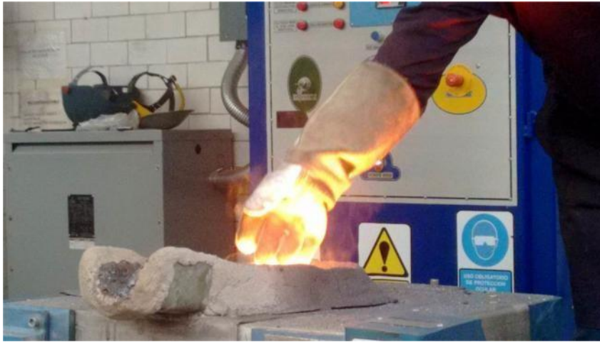
Figura 40 Adición de elementos aleantes.
