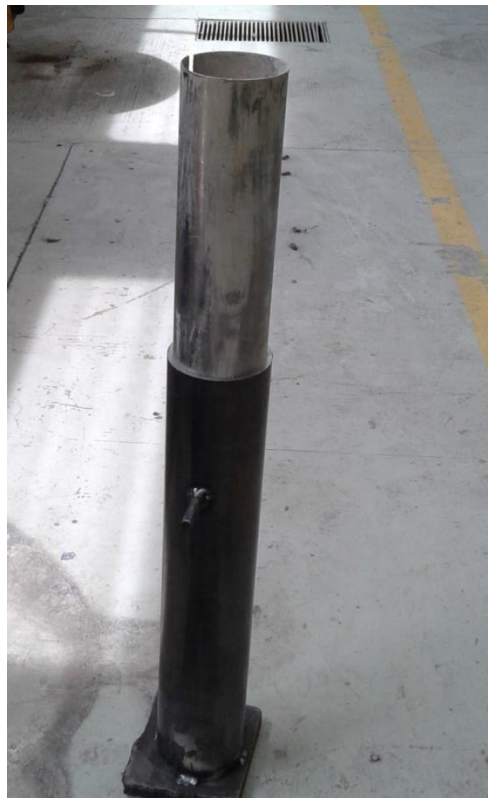
Figura 22 Introducción del tubo de menor espesor en la lingotera.
