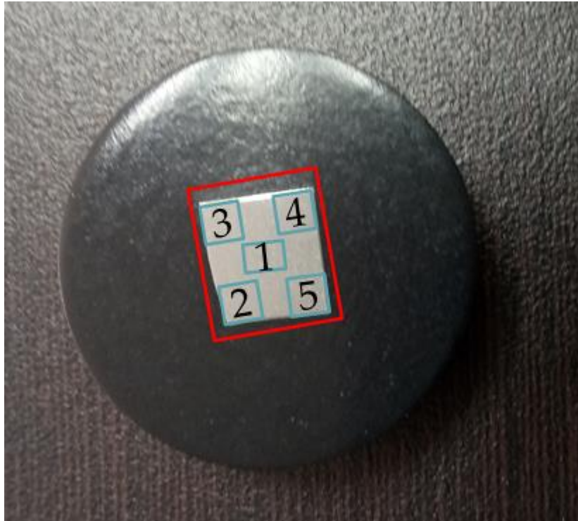
Figura 52 Zonas para toma de micrografías de todas las muestras.
