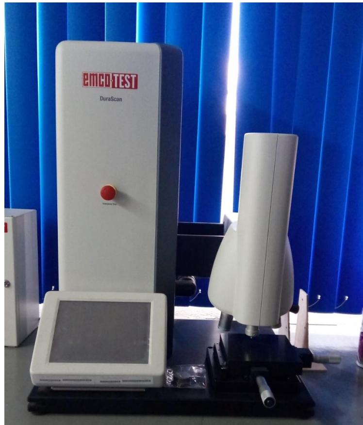
Figura 59 Durómetro Emco-Test para ensayos de dureza.
