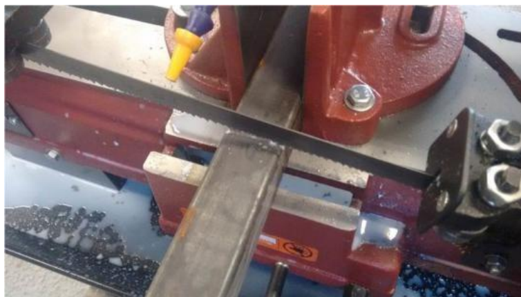
Figura 24 Corte en sierra cinta de las palanquillas de acero.
