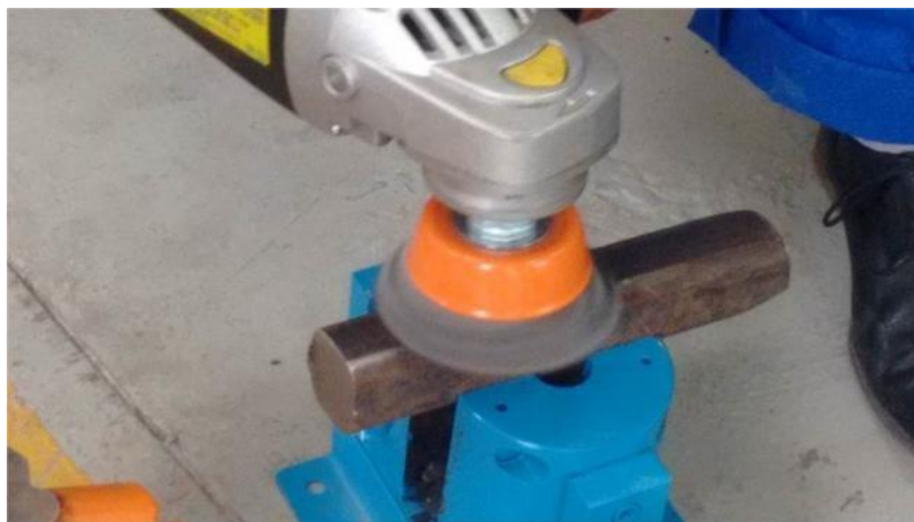
Figura 28 Limpieza de la palanquilla de acero
