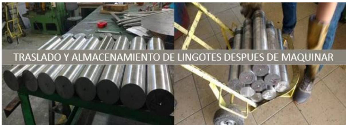
Figura 88 Maquinado final de los lingotes de acero colados 38MnV11S+Ti
