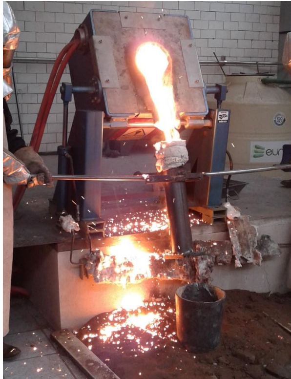
Figura 31 Técnica de vaciado de metal alrededor de 1700°C.
