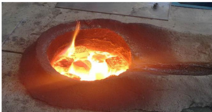
Figura 36 Metal fundido en un 80%.
