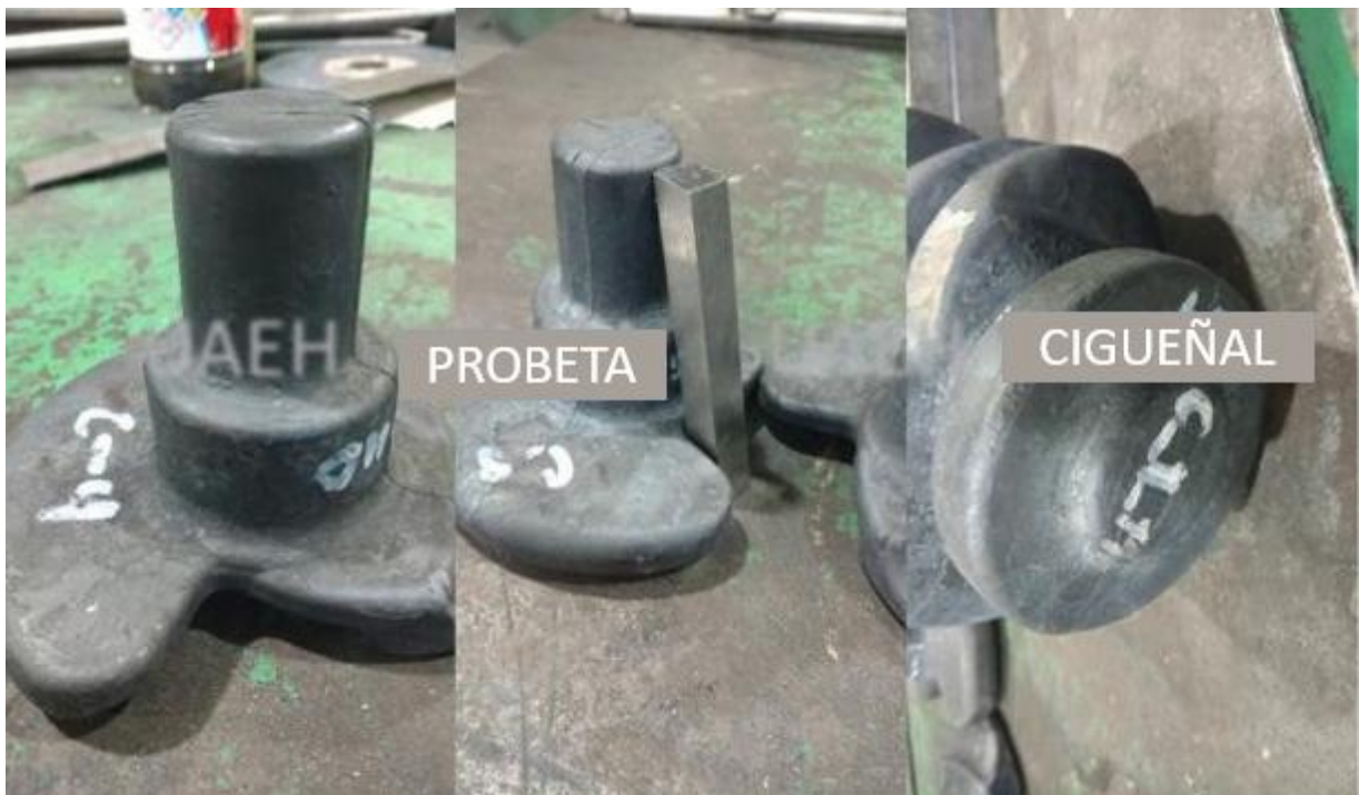
Figura 89 Corte de cigüeñal para el maquinado de probetas de tensión, Charpy y fatiga de acero forjado 38MnV11S+Ti
