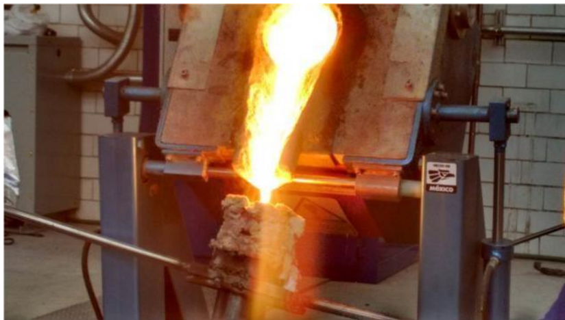
Figura 30 Proceso de vaciado del acero.
