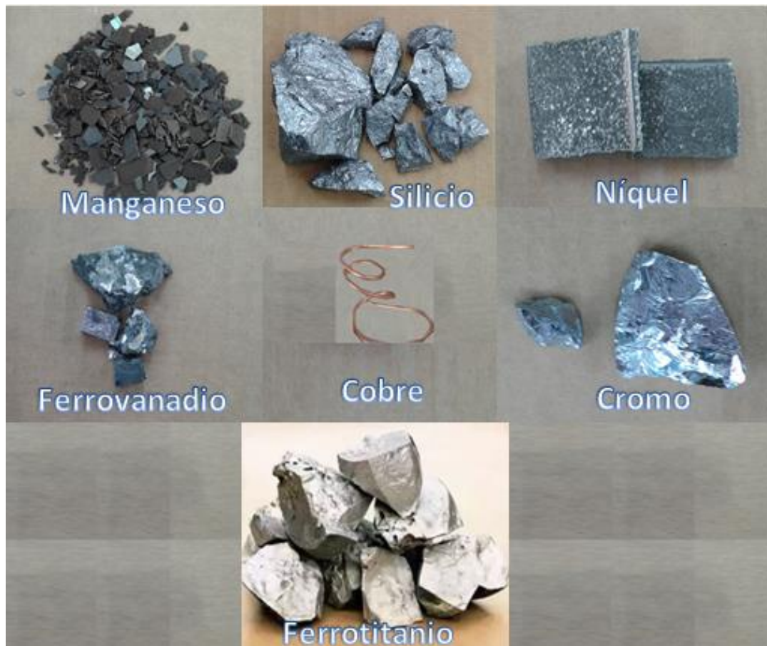
Figura 16 Elementos aleantes que se adicionaron al material base.
