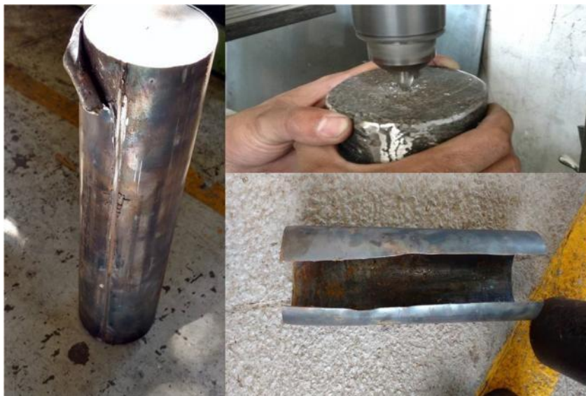
Figura 84 Corte y extracción de lingotes de acero colados 38MnV11S+Ti
