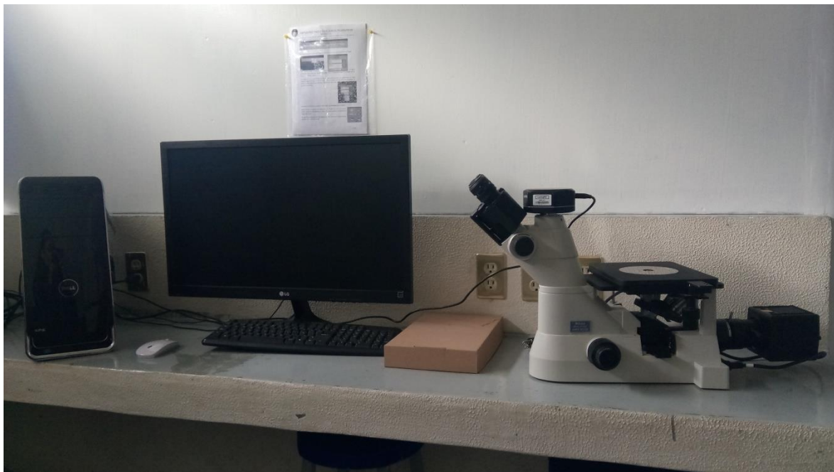
Figura 55 Microscopio óptico y equipo para análisis metalográfico.
