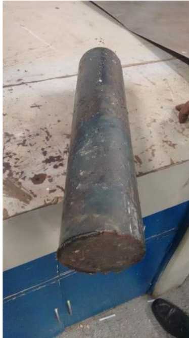
Figura 48 Lingote fundido y listo para ser maquinado a las dimensiones de forja.
