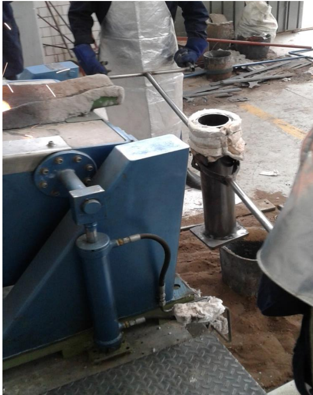
Figura 43 Vaciado del material en las lingoteras.
