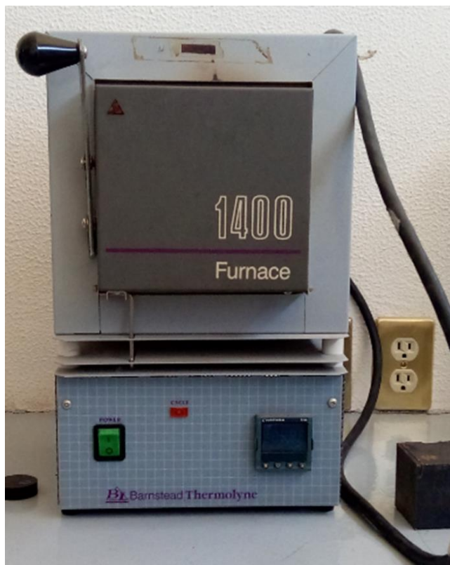
Figura 53 Mufla Furnace 1400 para tratamientos térmicos.
