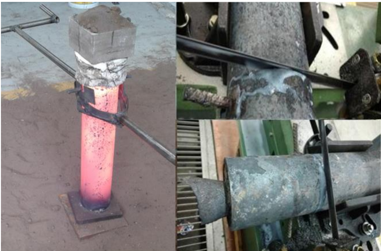
Figura 82 Fundición y corte de lingotes de acero colados 38MnV11S+Ti
