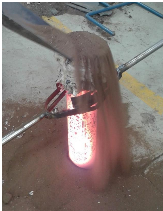
Figura 44 Reducción del rechupe a través de arena sílica.
