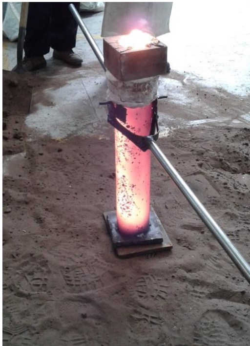
Figura 46 Solidificación del metal en lingotera metálica.
