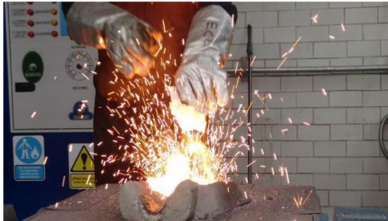
Figura 41 Adición de elementos micro-aleantes.
