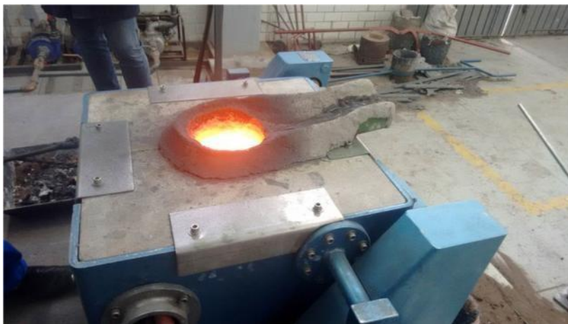
Figura 39 Metal fundido desoxidado con aluminio.
