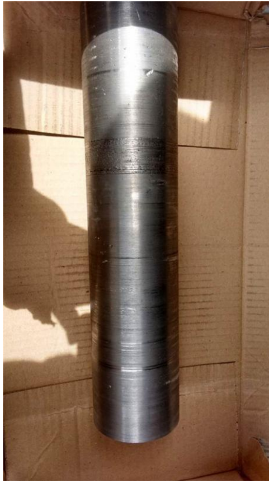
Figura 50 Lingote maquinado y preparado para ser forjado.
