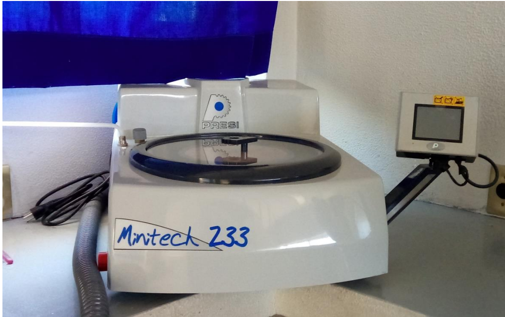
Figura 54 Pulidora metalográfica para la preparación de probetas.
