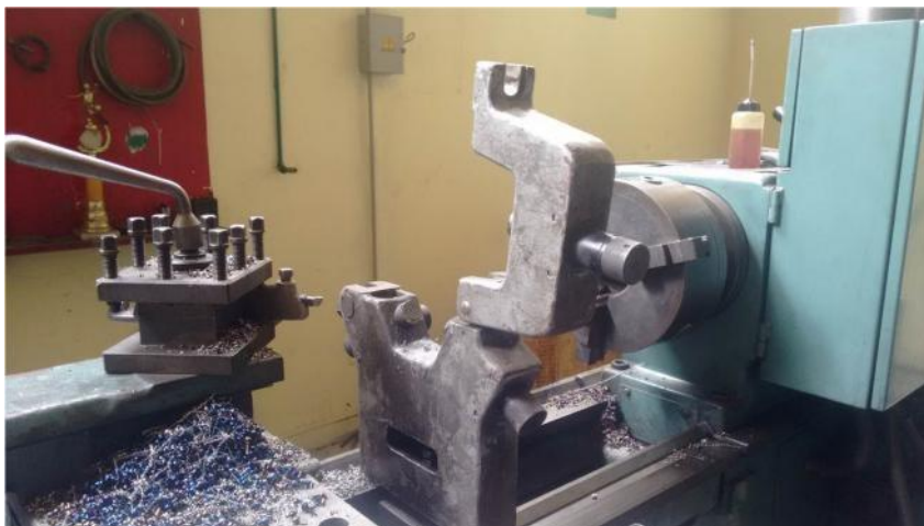
Figura 49 Proceso de maquinado de los lingotes.
