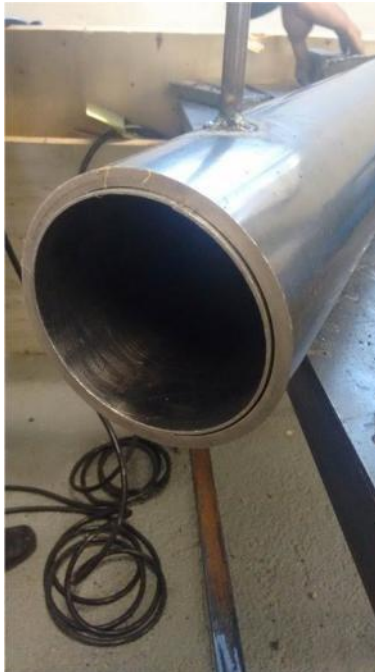
Figura 23 Encamisado de la lingotera de acero para obtener un diámetro de 9.6 cm y acelerar el efecto chill.
