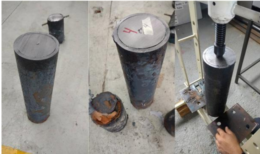
Figura 83 Corte y extracción de lingotes de acero colados 38MnV11S+Ti
