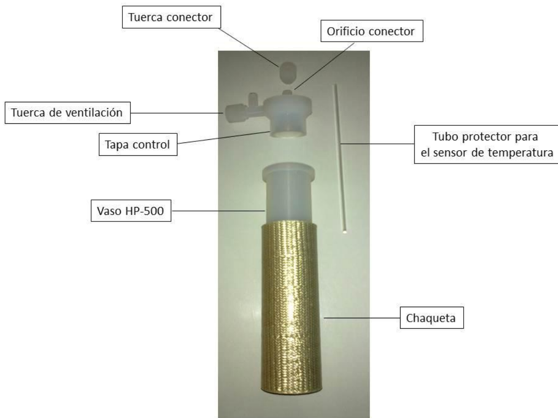
Figura 6. Ensamble del vaso control HP-500.
