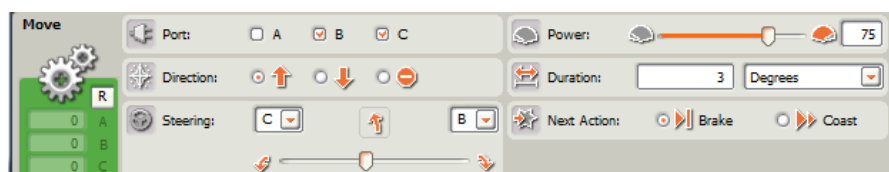
Ilustración 27. Configuración de la acción move en caso de capte poca luz (Fuente propia).
