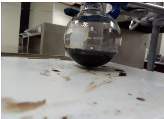
Figura A3. Suspensión acuosa de grafito al 1%. Antes de la reacción de oxidación la suspensión se muestra uniforme.
