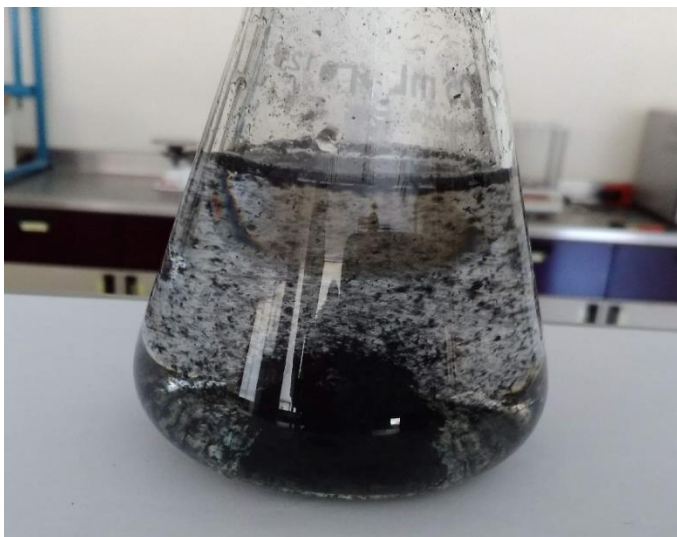
Figura A9. Crudo de reacción, adiciones completadas. Después de la reacción de oxidación ultrasónica la suspensión pierde uniformidad, aunque la pérdida de uniformidad es menor comparado con el método convencional de calentamiento.
