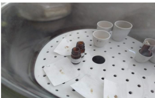
Figura A11. Conservación de muestras de óxido de grafeno/grafito con \text{SiO}_2 como desecante
