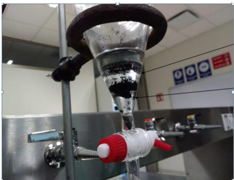
Figura A5. Separación y lavado con disolvente orgánico del crudo acuoso de reacción. Se hipotetizo que la fase superior de disolvente orgánico (benceno o tolueno) se enriquece con grafeno/grafito sin reaccionar, mientras que la fase inferior acuosa asocia la mayor proporción de productos de oxidación por enlaces de hidrógeno.
