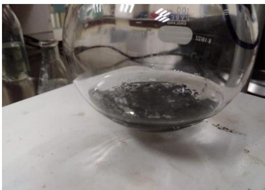
Figura A4. Crudo de reacción, adiciones completadas. Después de la reacción de oxidación la suspensión pierde uniformidad.
