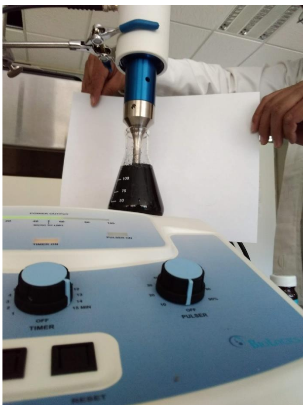
Figura A7. Oxidación/Exfoliación ultrasónica de grafito.
