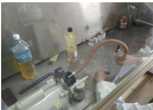
Figura A10. Secado de las muestras con aire a presión.
