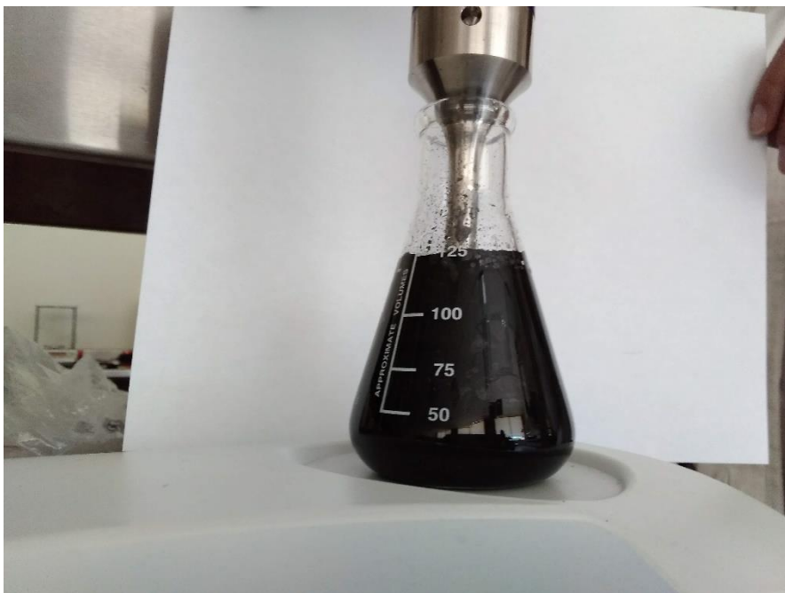
Figura A8. Suspensión acuosa de grafito al 1%. Antes de la reacción de oxidación la suspensión se muestra uniforme.
