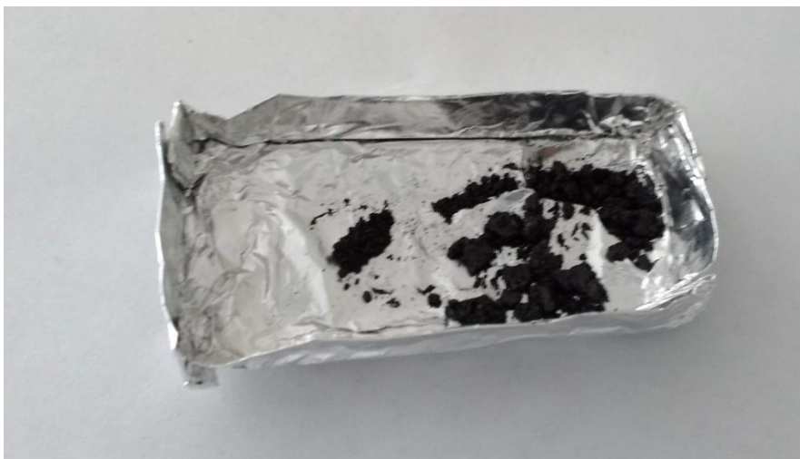
Figura A6. Muestras de productos oxidados después del secado en estufa a 70°C.
