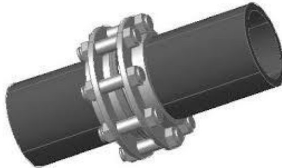
Fig. 9 Uniones de tubería por medio de bridas.
