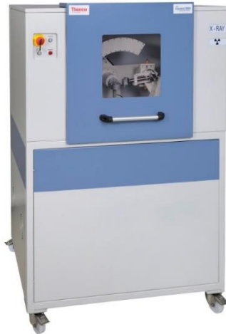
Figura IV.9. Difractómetro Inel, modelo EQUINOX 2000. Fuente: Thermofisher 2016.
