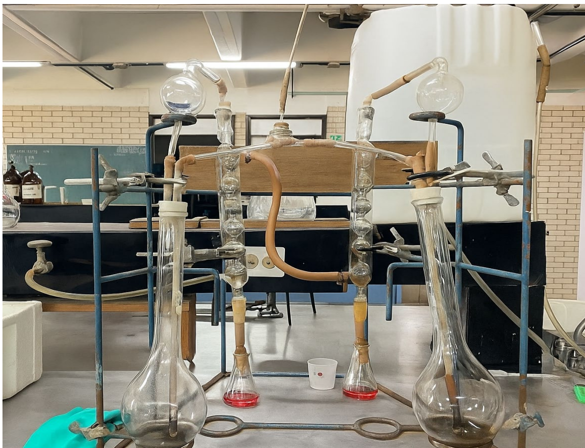
Figura 4. Sistema de Kjeldahl para la cuantificación del Nitrógeno total.
