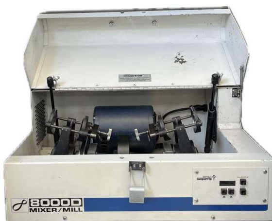
Figura 9. Molino de alta energía marca SPEX modelo 8000 D.
