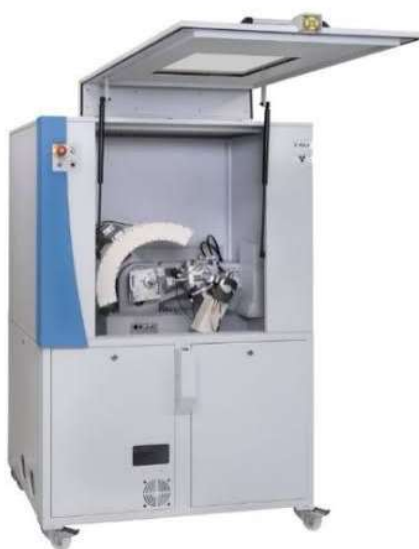
Figura 11. Difractómetro Inel Equinox 2000.
