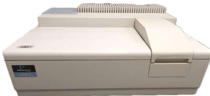
Figura 13. Espectrofotómetro de reflectancia difusa Perkin-Elmer Lambda 35.
