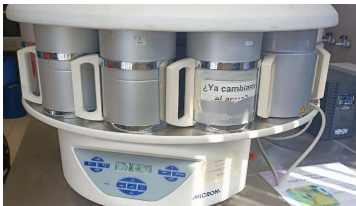
Figura 15. Procesador automatizado de tejidos marca Microm, mod. STP-120.
