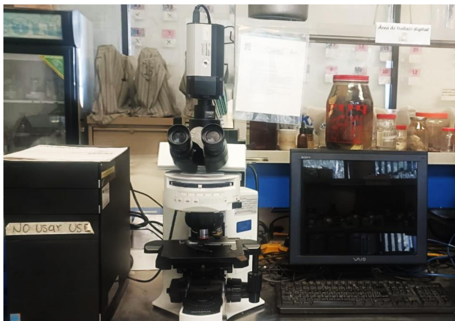
Figura 20. Microscopio compuesto de campo claro, marca Olympus, mod. BX41.
