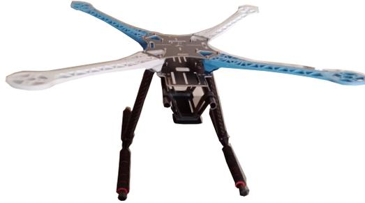
Figura 3.1: Frame del kit armable comercial.
