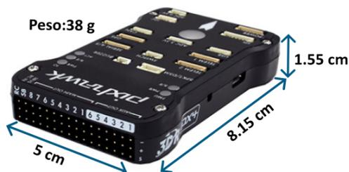
Figura 3.3: Dimensiones y peso del Pixhawk.
