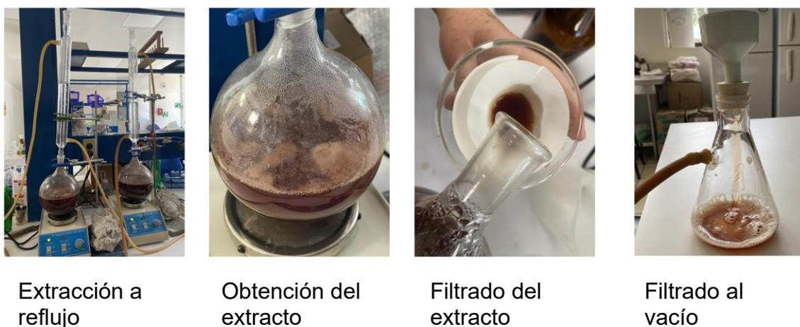
**Figura 8. Método para obtención de extracto acuoso de la corteza de roble.**
