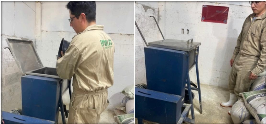
**Figura 8.** Mezclado de ingredientes para elaboración de dietas, utilizando una máquina horizontal de doble hélice.
