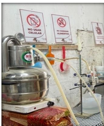
**Figura 2.** Obtención de hidrolato de tomillo (*T. vulgaris*) mediante un hidrodestilador.
