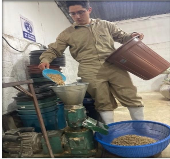
**Figura 9.** Peletizado de alimento en una máquina SKJ-120.
