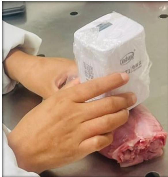
**Figura 28.** Colorímetro marca Linshang colorimeter (Shenzhen Lingshang Technology Co., Shenzhen, China)
