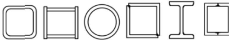
Figura 4.1.4 Secciones transversales de contravientos (Tapia-Hernández, s.f.)
