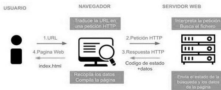
Figura 1. 2. Proceso de Comunicación por medio de HTTP. Adaptado de El proceso de comunicación HTTP. Por TechWebPe. (2021). TechWebPe. (<https://techwebpe.com/dominios/http-que-es-como-funciona/>).
