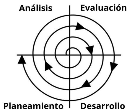
Figura 2.2: Estructura del modelo Espiral
