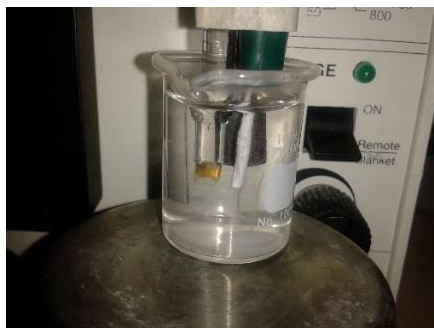
Figura 2. Modificación del electrodo de plata mediante la cronoamperometría para la obtención del par Ag/AgIbu. Se utilizó una solución 0.05 M de ibuprofenato de plata en 0.1 M de \text{NaNO}_3 .
