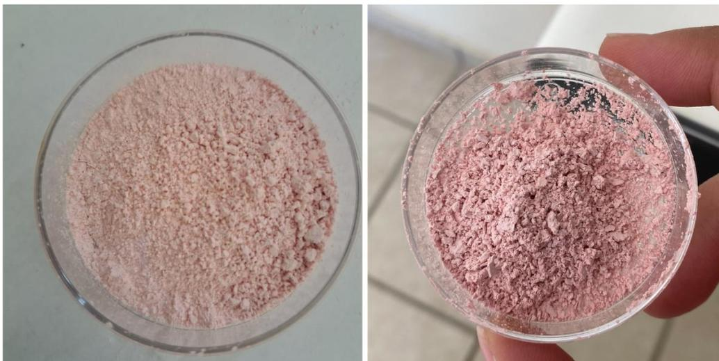
**Figura 7.** Polvo con microencapsulados de mezclas de fresa – jamaica en 75%-25% y 50%-50%, respectivamente, obtenidos mediante la técnica de secado por aspersión.
