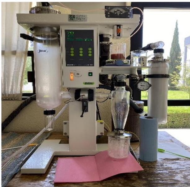
**Figura 6.** Secado de muestras de mezclas de fresa-jamaica en secador Buchi B-191.
