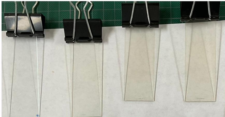
**Figura 3.3:** Películas delgadas sintetizadas por *spin-coating*. De izquierda a derecha se observan las muestras: ZnO (control), ZnO- $\text{Fe}_3\text{O}_4$ , ZnO-Curcumina y ZnO- $\text{Fe}_3\text{O}_4$ -Curcumina.
