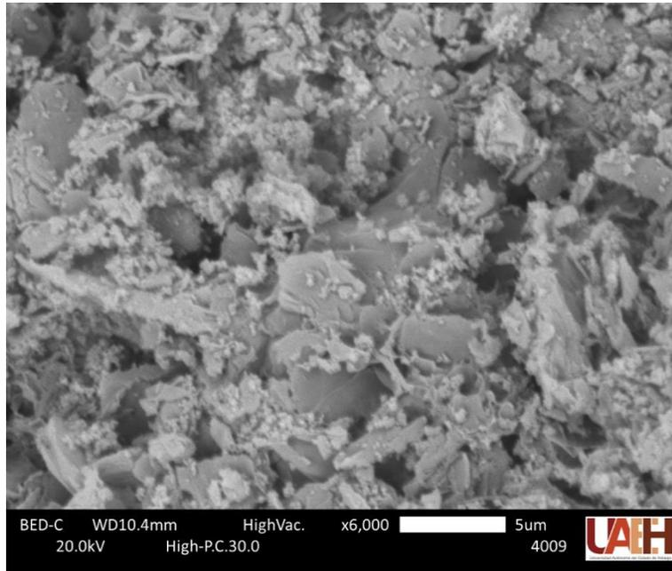
**Figura 16.** Micrografía SEM de Fe<sub>3</sub>O<sub>4</sub>@GO
