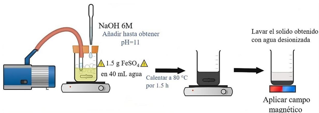
Figura 8. Síntesis de Fe<sub>3</sub>O<sub>4</sub> por oxidación parcial de Fe (II).
