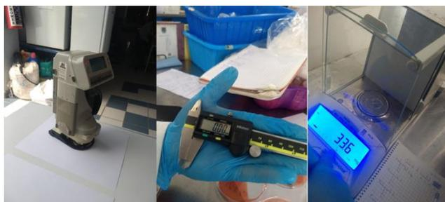
*Figura 3 Obtención de espesor, color y transparencia en películas*
