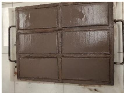
**Figura 20.-** Moldeo por compresión manual de pasta cerámica para obtener probetas de ladrillo.
