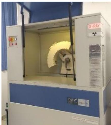
**Figura 24.-** Difractómetro de Rayos X, marca INEL, modelo Equinox 2000.
