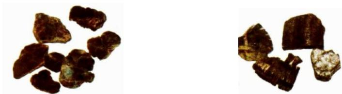
Figura 11.- Vermiculita antes y después de expandirse. [14]
